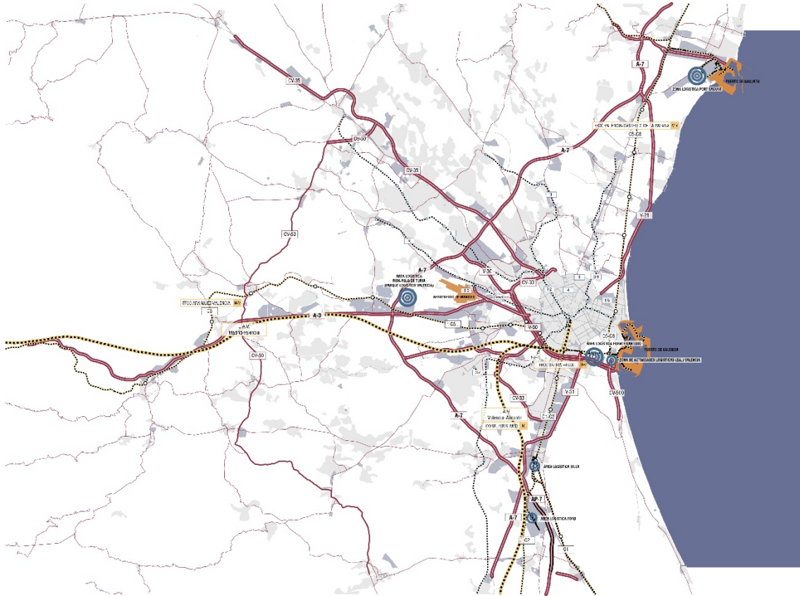
Fig. 08 Infraestructuras de transporte del Área Metropolitana de Valencia. En rojo la red de carreteras, en naranja los puertos y aeropuertos, y en azul las principales plataformas logísticas. Elaboración propia.
