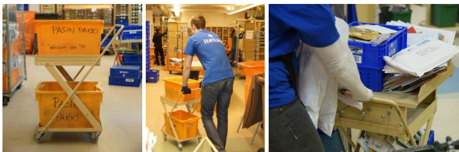
Kuva 34: Kärry on toimipaikan tärkeimpiä työn apuvälineitä. Kärryssä on mahdollisuus korkeussäätöön, mutta sitä harvemmin käytetään.
