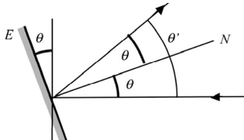
b)  $\theta'$  se obtiene fácilmente buscando el valor de su tangente en el triángulo rectángulo que se muestra en la figura (se considera la aproximación de ángulos pequeños). Una vez obtenido  $\theta'$ , aplicando el apartado a) se obtiene de forma inmediata el valor de  $\theta$ .
