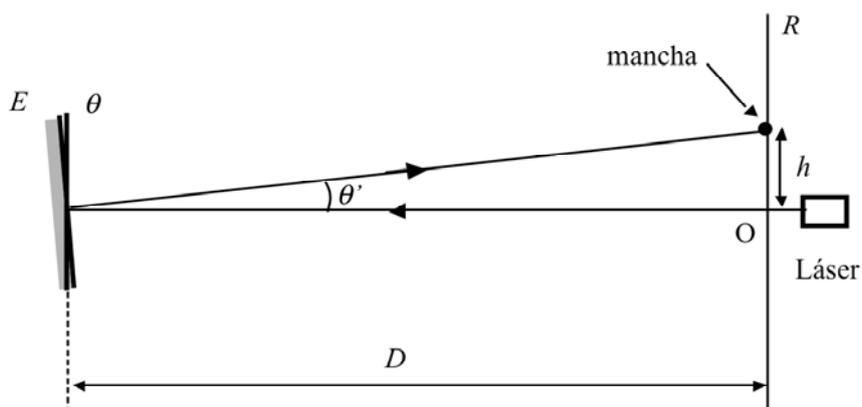
Si a continuación se sitúa, a la distancia  $d$  del espejo, una lente divergente  $L$  de focal  $f'$  y centrada respecto de la dirección del rayo anterior, se observa en la regla una nueva mancha a una nueva altura  $h'$  según se muestra en la figura.
