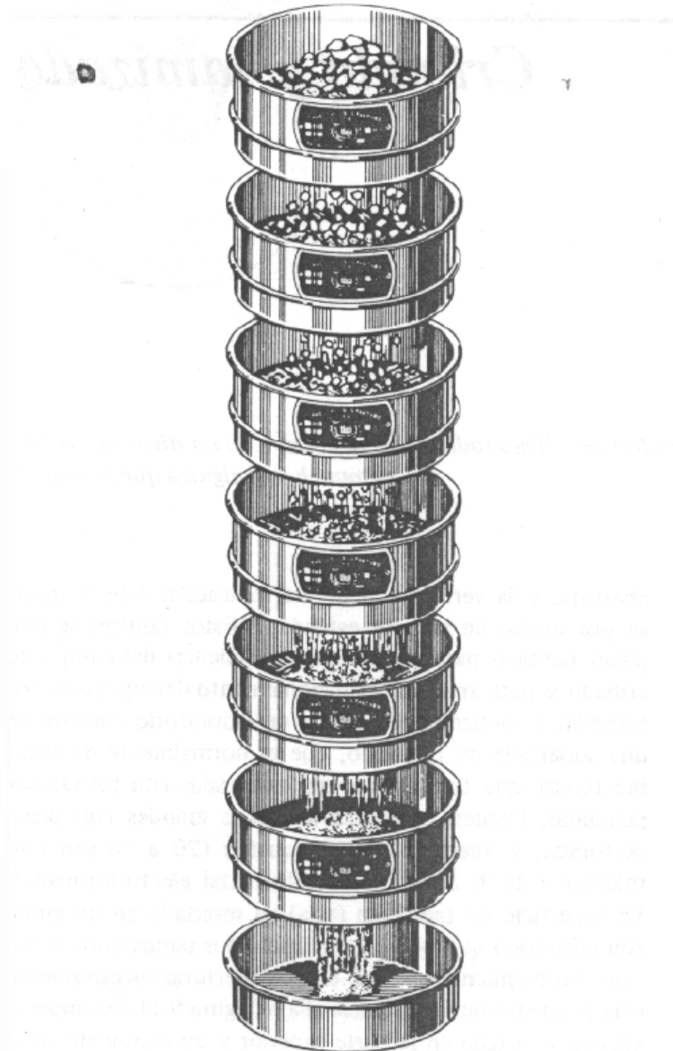
Figura 9.1 Principio del tamizado de laboratorio con un apilamiento de tamices. (Cortesía de Tyler Industrial Products.)
