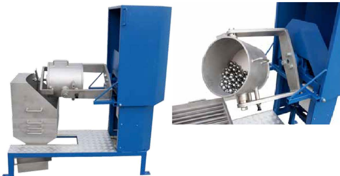
Figura 10. Molí de boles pel test de Bond
