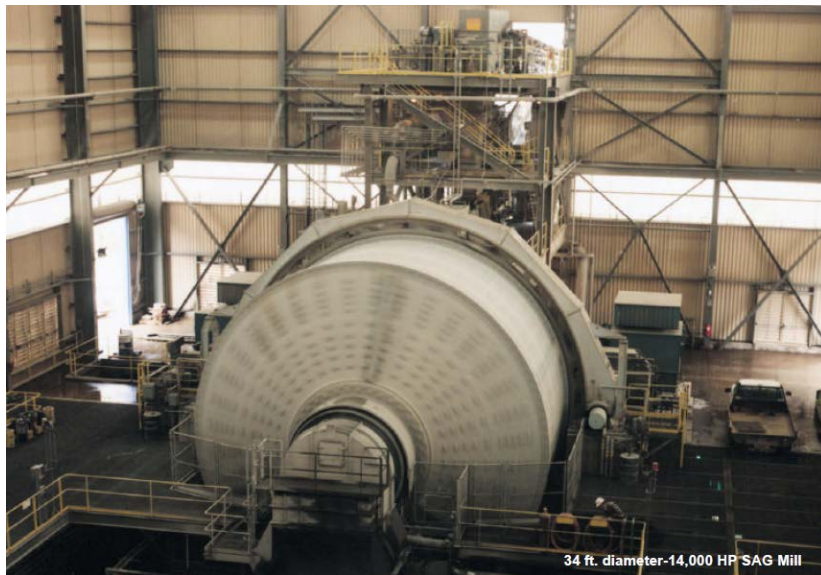
Aspecte d'un moli AS/SAG amb el rati D/L alt, amb reixeta i sortida cònica.
