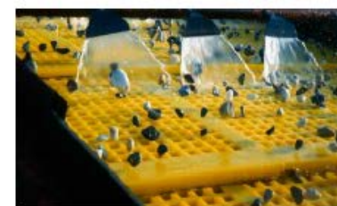
Trellex Stepflex con goma flexible impide la obturación
