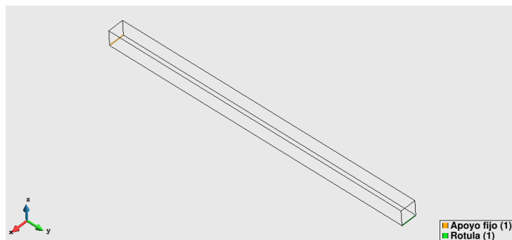
Ilustración 37: Izq. direcciones bloqueadas el apoyo fijo y drcha. direcciones bloqueadas en la rótula.
