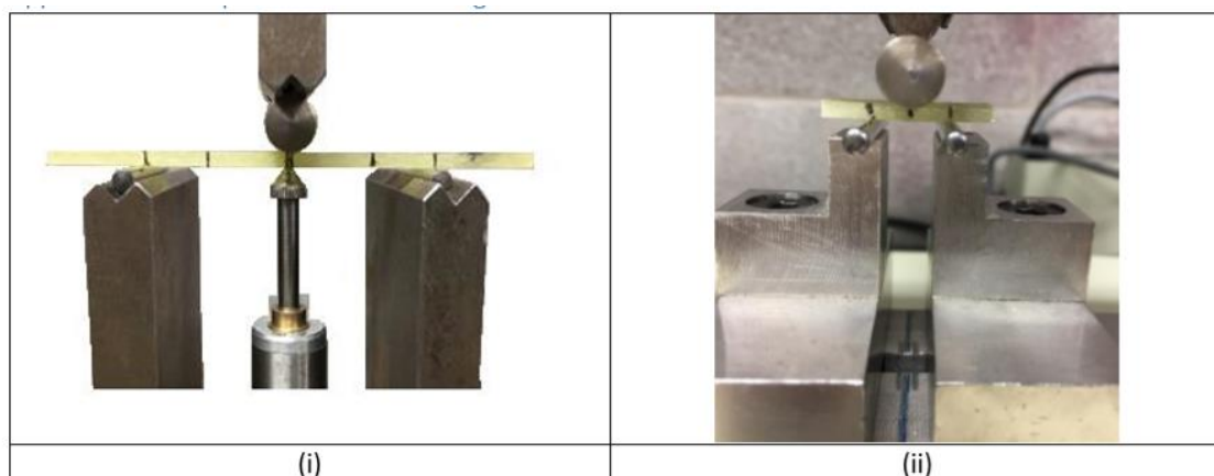
Ilustración 7:(i) Prueba de los 3 puntos. (ii) Prueba de cizallamiento interlaminar. FiberShip (1)
