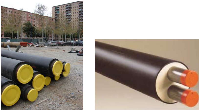
Figura 2. Tubs preaïllats. Esquerra - tubs de diferents diàmetres. Dreta - bitub, tubs d'anada i tornada dintre de la mateixa camisa d'aïllament
