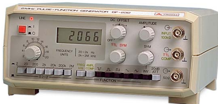
Figura 4.10. Fotografia d'un generador de funcions.
