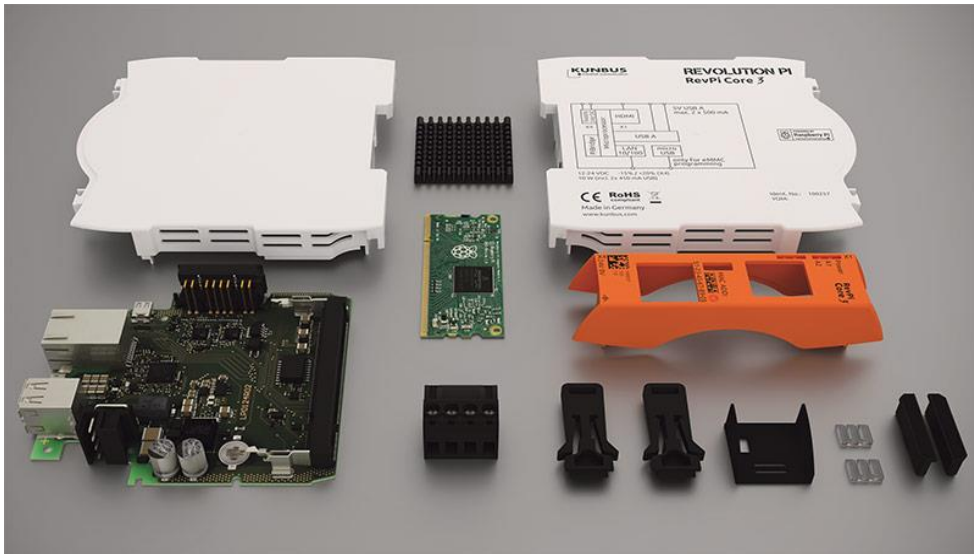
Figura 29. Componentes del modelo Revolution Pi RevPi Core 3+. Fuente: Revolution Pi.
