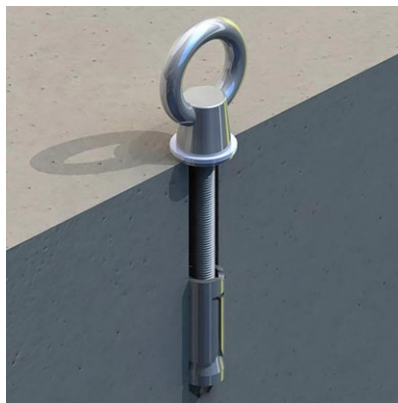
Figura 15 – Exemplo de ponto de ancoragem em obra
