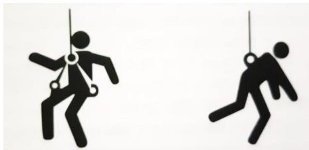
Figura 12 – Posição após queda (anel com fixação frente e fixação trás) (retirado de [3])
