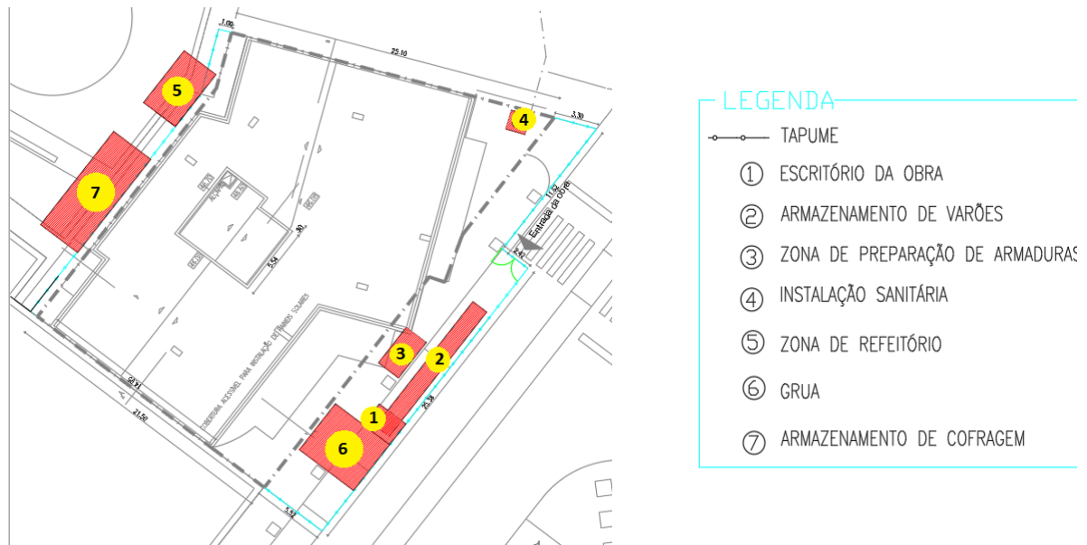
Figura 3.5 – Estaleiro da obra
