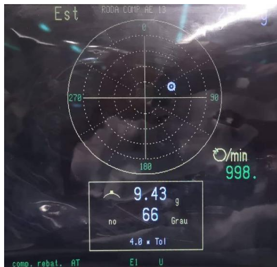
Figura 58- Foto do peso de desequilíbrio e respetivo ângulo
