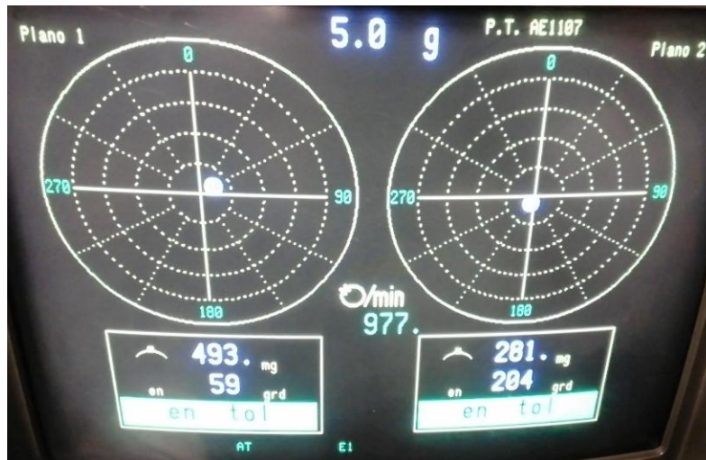
Figura 80- Representa o rotor de turbina LPT, já equilibrado
