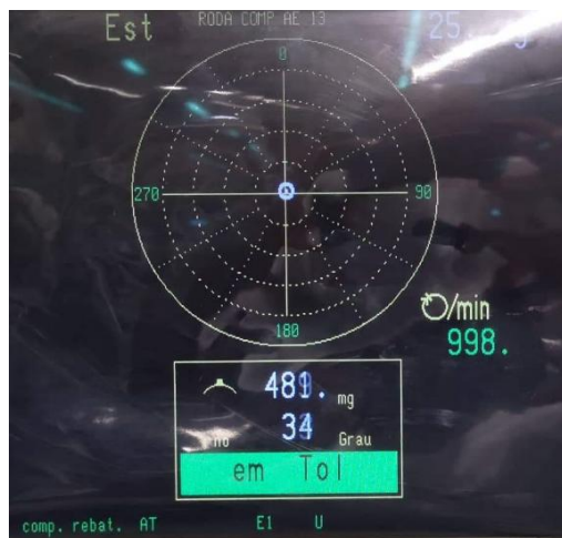
Figura 59- Foto da roda já equilibrada, apresentando valores de desequilíbrio residual
