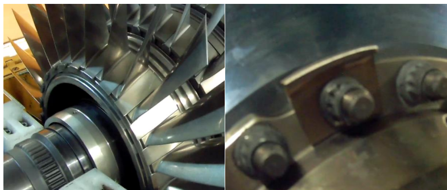
Figura 65-Ex: troca de blades no 1º andar e anilha / peso de equilíbrio no 14º andar
