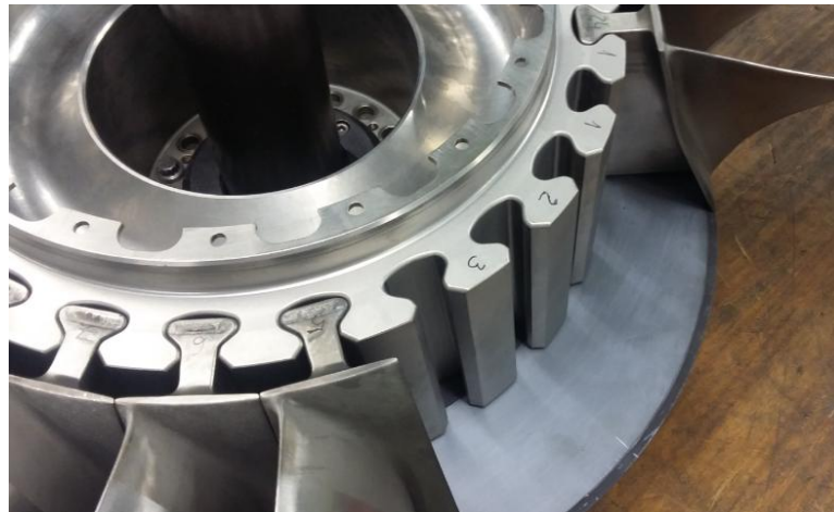
Figura 50- Ex: da distribuição das blades no disco da “FAN”
