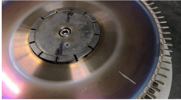
Figura 60- O risco feito com lápis de prata indica a posição do desequilíbrio residual
