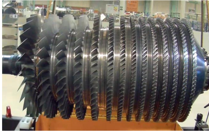
Figura 62- Rotor de compressor com 14 andares de compressão
