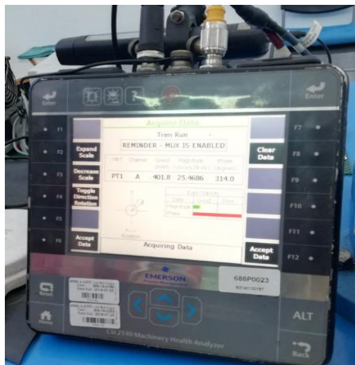
Figura 36 - Foto do desequilíbrio, depois do primeiro peso de correção
