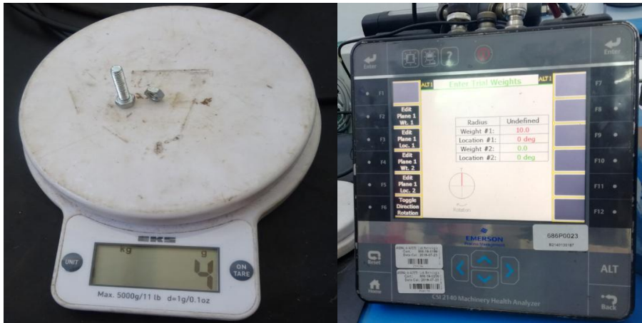
Figuras 32 e 33 - Balança digital | Indicação do peso de teste
