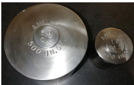
Figura 47- Pesos utilizados para contrabalançar o braço da balança de momentos
