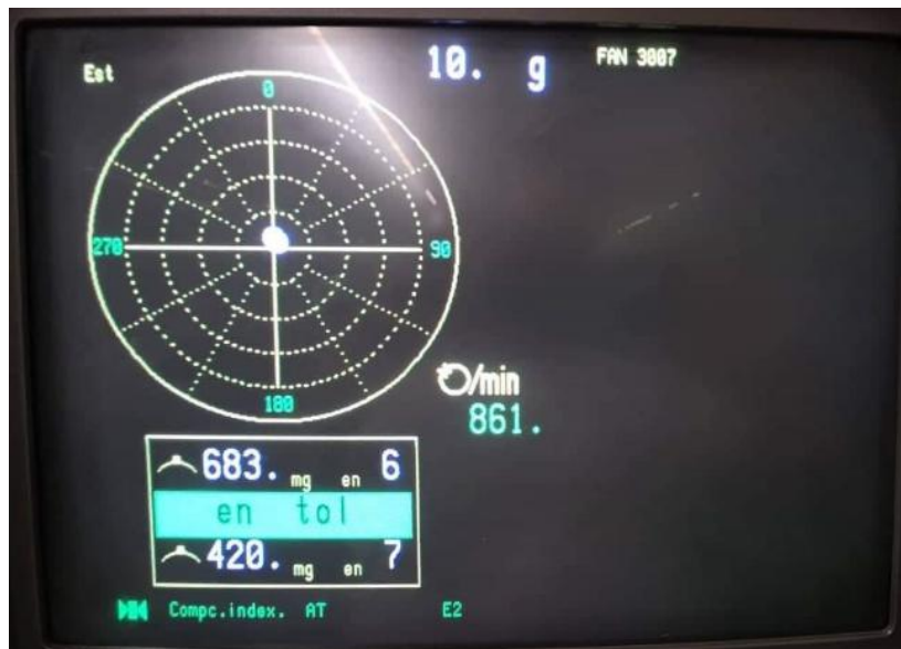
Figura 54- Representa o equilíbrio final do rotor da FAN
