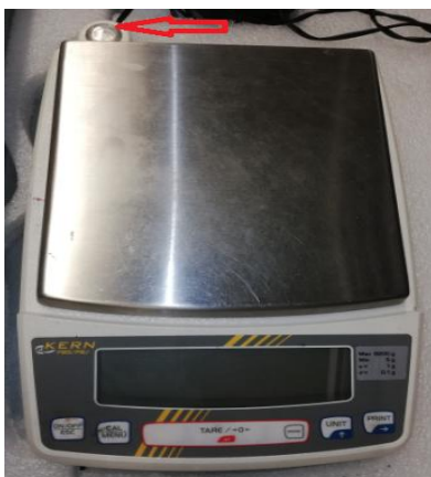
Figura 45- Balança decimal, a seta aponta para o nível da balança, que deve ser sempre confirmado antes de iniciar a pesagem.
