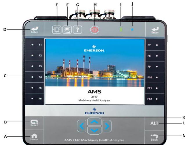
Figura 23- Algumas das funções da 2140 Machinery Health Analyzer [33]
