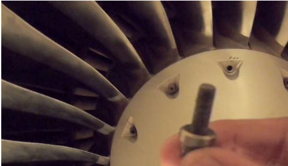
Figura 91- Três marcas que indicam a localização do segundo parafuso
