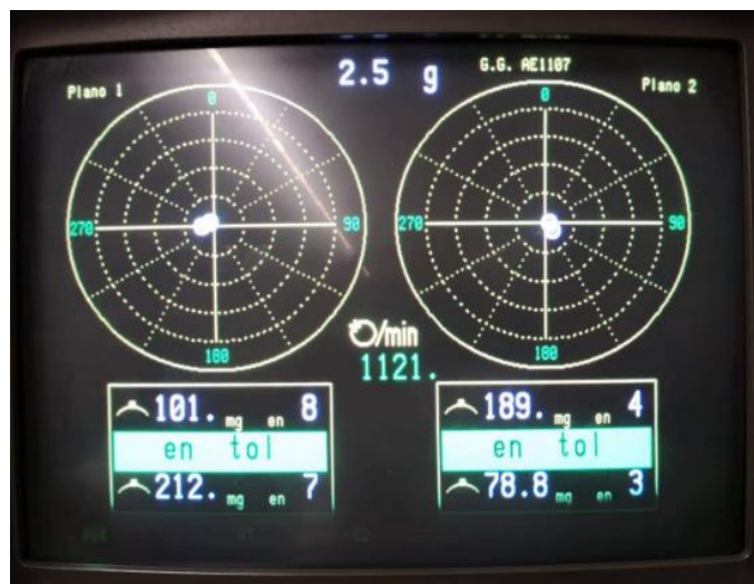
Figura 75- Foto do desequilíbrio residual da HPT
