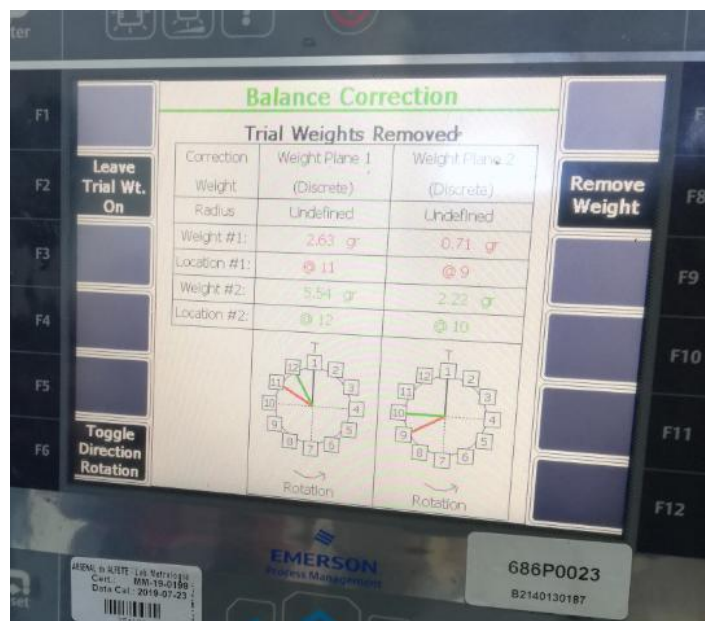
Figura 40- Indicação dos pesos de correção e respetivo ângulo
