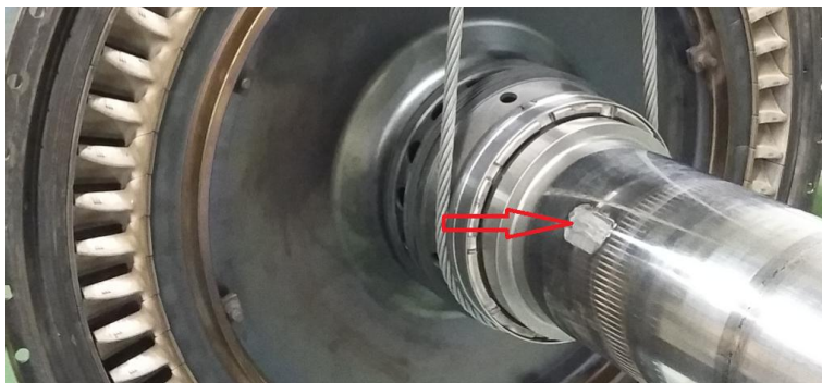
Figura 71- Ilustrativa da equilibragem do mandril, retirando material.
