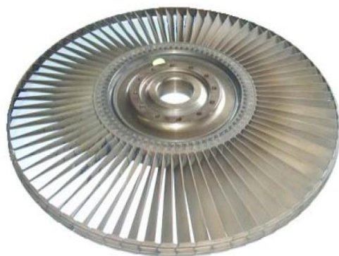
Figura 69- Disco de turbina, já com as pás montadas
