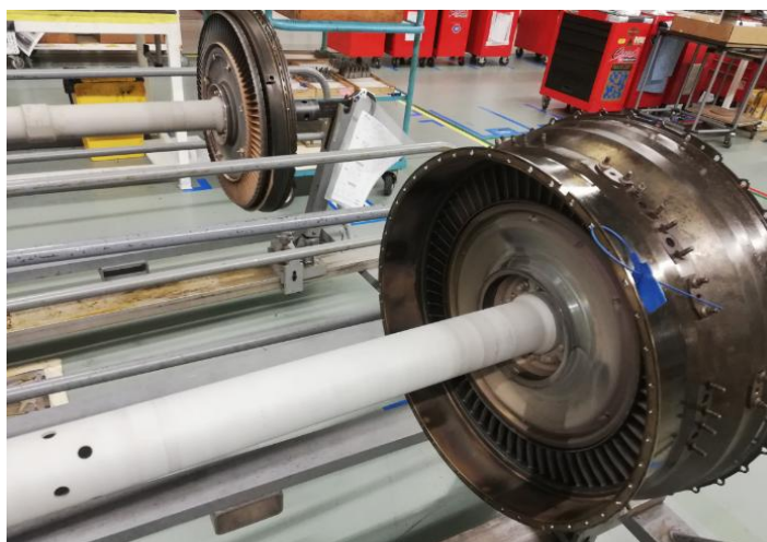
Figura 76- Ex: de duas turbinas, uma com o cárter da parte estática montado e a outra já sem esse cárter. (em condições de ir equilibrar)
