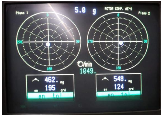
Figura 66 - Observa-se o equilíbrio final do rotor de compressor
