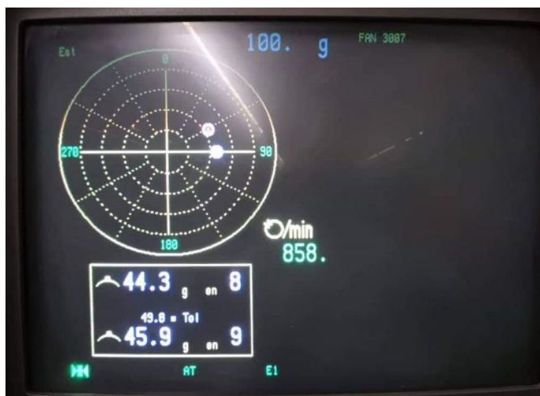
Figura 53- Representa o desequilíbrio inicial do rotor da FAN
