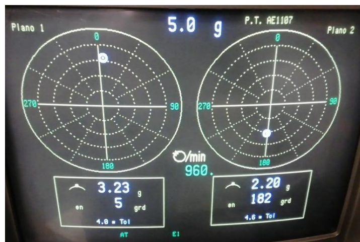
Figura 78- Representa o desequilíbrio inicial da turbina LPT
