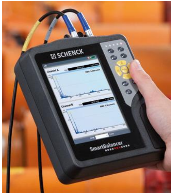
Figura 14- Espectro de frequências visto na Smart Balancer [33]
