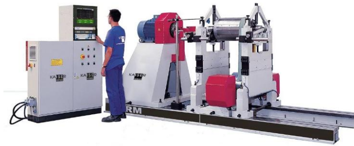
Figura 6- Máquina de equilibrar horizontal KAISER, com possibilidade de transmissão por cardan ou correia [30]
