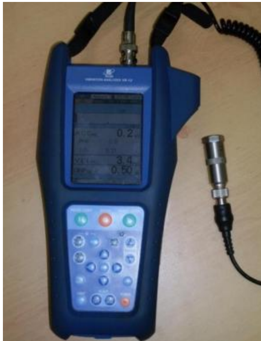
Figura 1 - Equipamento portátil de análise de vibrações com capacidade FFT [12]
