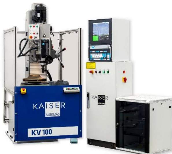
Figura 8- Máquina de equilibrar vertical KAISER [30]
