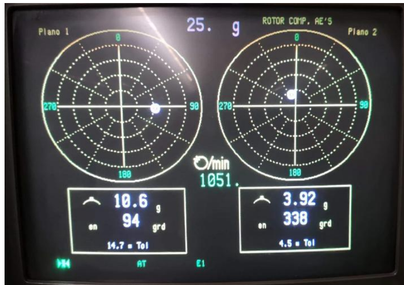
Figura 64- Observa-se o desequilíbrio inicial do rotor de compressor
