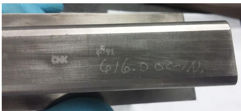
Figura 49- Ex.de uma marcação do momento da pá.
