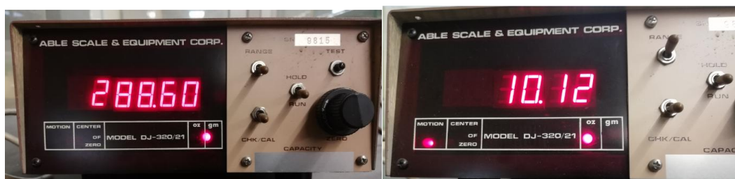
Figura 48- O analisador tem a possibilidade de dar a informação em “oz” ou “gm”
