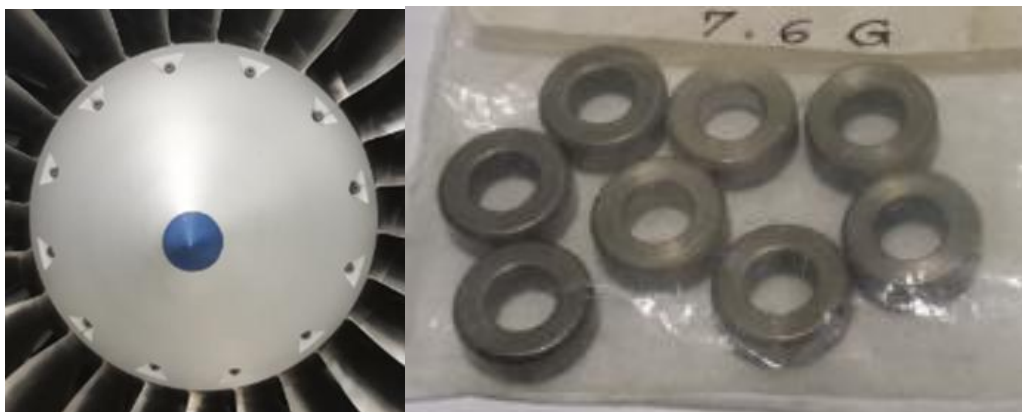
Figura 84- Parafusos do spiner e Ex: de pesos para instalar
