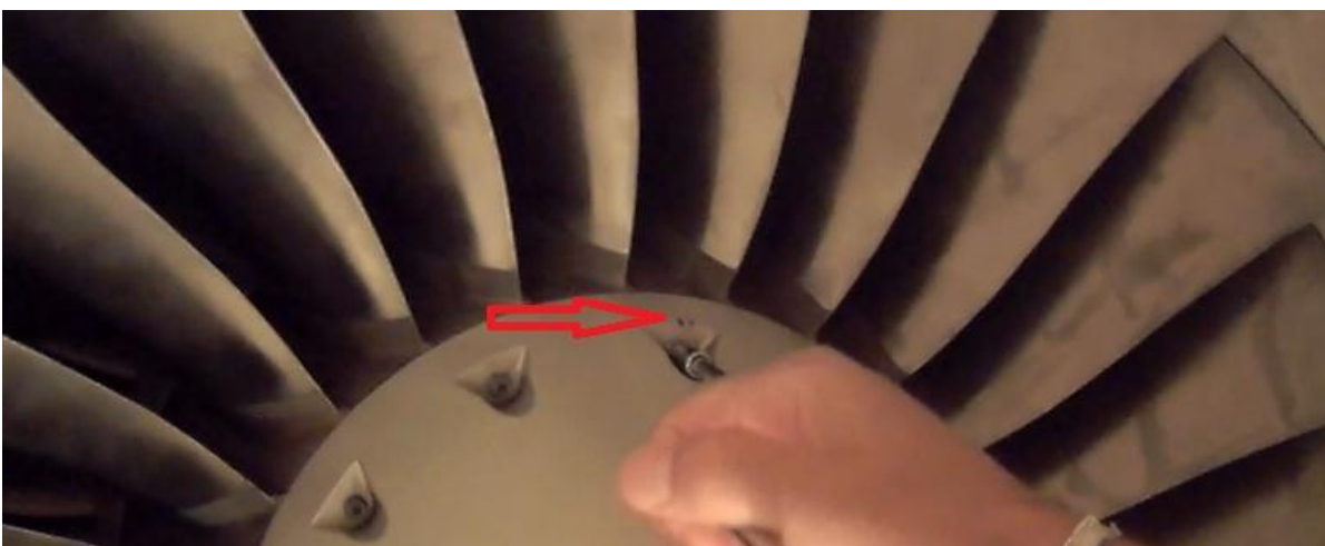
Figura 88- Duas marcas que indicam a localização do segundo parafuso
