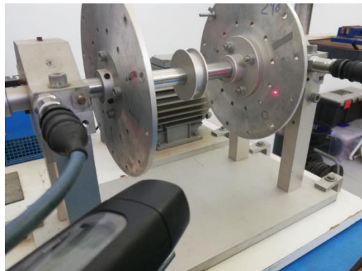
Figura 37- Modelo utilizado para equilibrar em dois planos
