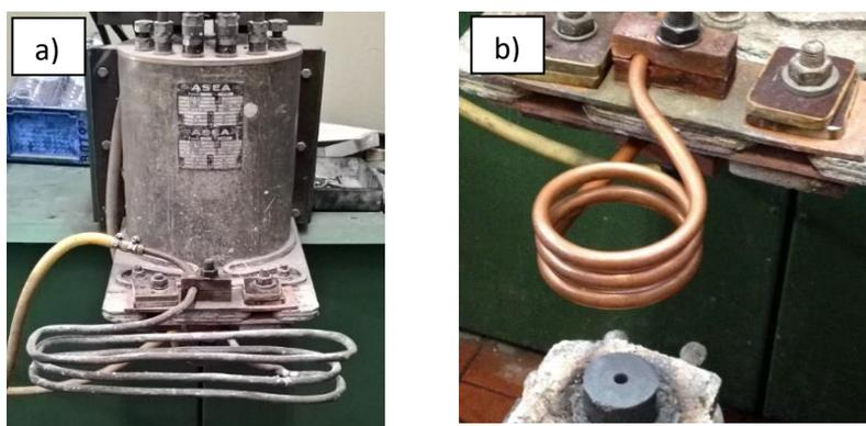
Fig. 14 - a) Máquina de indução; b) indutor desenvolvido.
