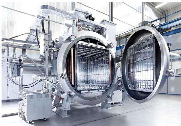
Fig.11- Forno de vácuo [1].
