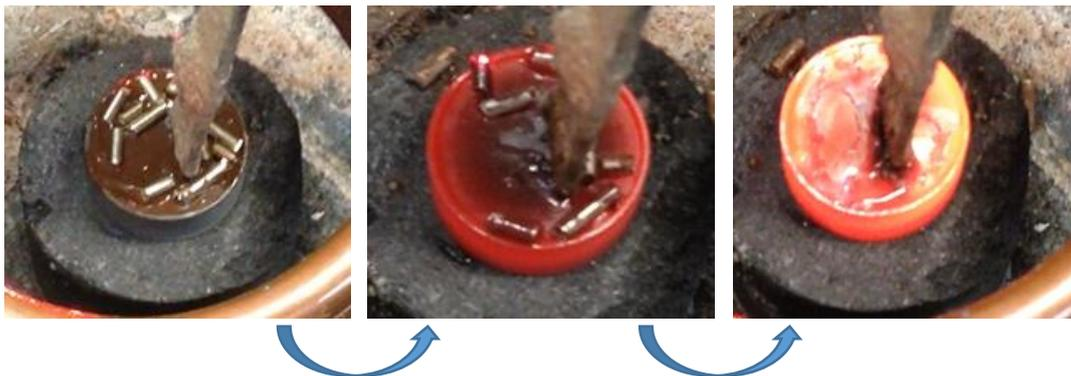
Fig. 12 - Evolução do comportamento da liga de brasagem 4900, num ensaio de molhabilidade.
