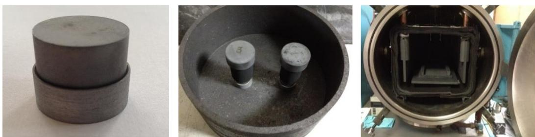
Fig. 15 - Sequência de preparação das amostras para brasagem sob vácuo.
