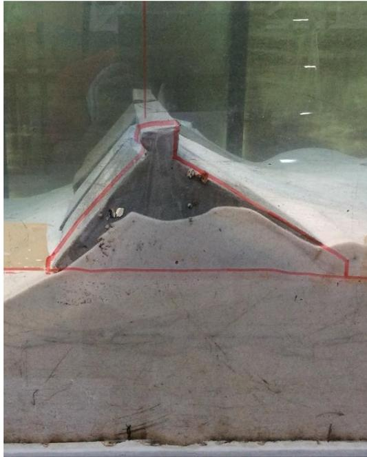
Fig. 4.71 - Bloco na posição final (o desenho a vermelho no vidro representa a posição inicial).
