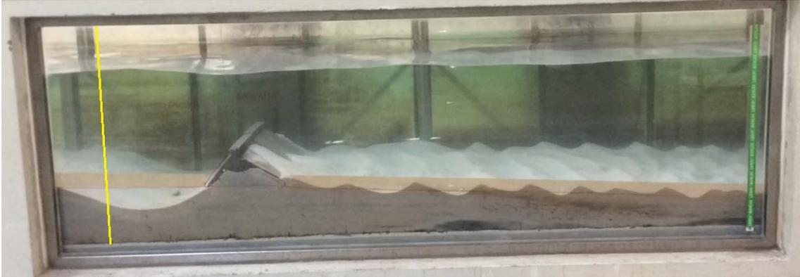
Fig. 4.69 - Estado final do perfil transversal da praia depois da ação das ondas, para o nível de PM.
