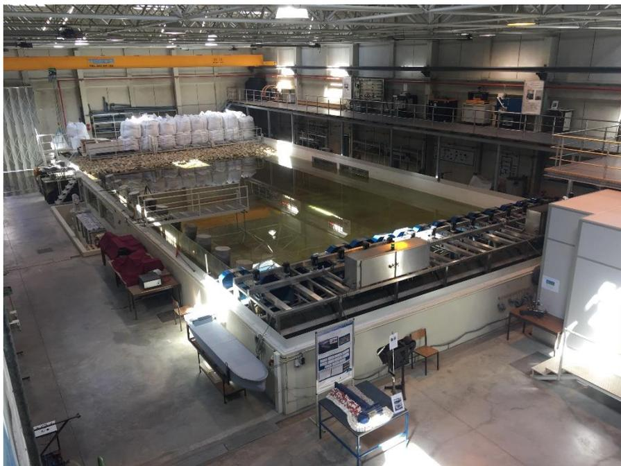
Fig. 4.2 - Visão geral do tanque de ondas, pás geradoras, praia de enrocamento e sala de controlo.
