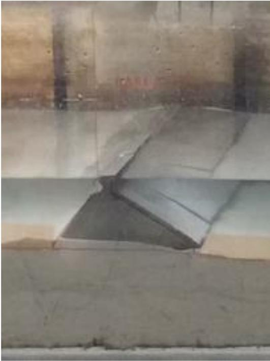
Fig. 4.66 - Bloco na posição inicial, antes de ser testado para o nível de BM.
