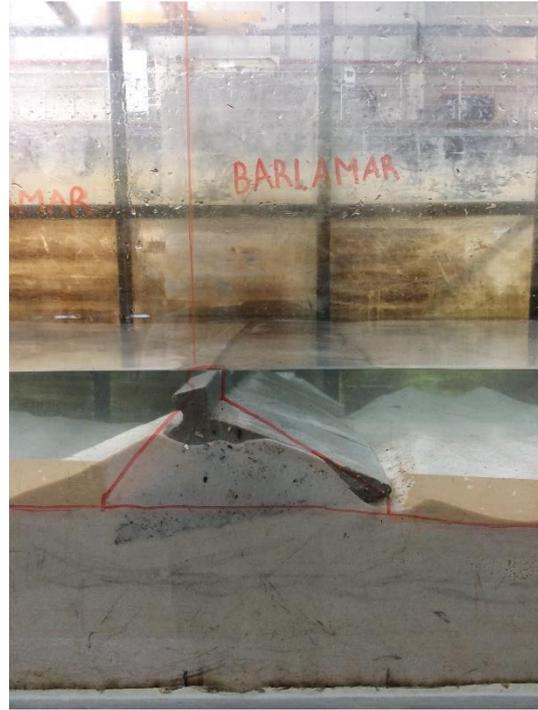
Fig. 4.67 - Bloco na posição final (o desenho a vermelho no vidro representa a posição inicial).
