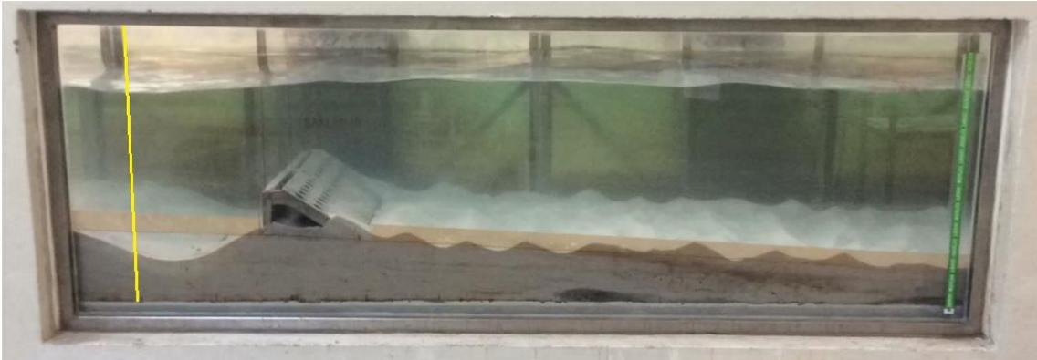
Fig. 4.59 - Estado final do perfil transversal da praia depois da ação das ondas, para o nível de PM.
