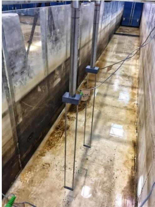
Fig. 4.6 - Sondas instaladas no canal de ensaios, sendo visível ao fundo o batedor utilizado.
