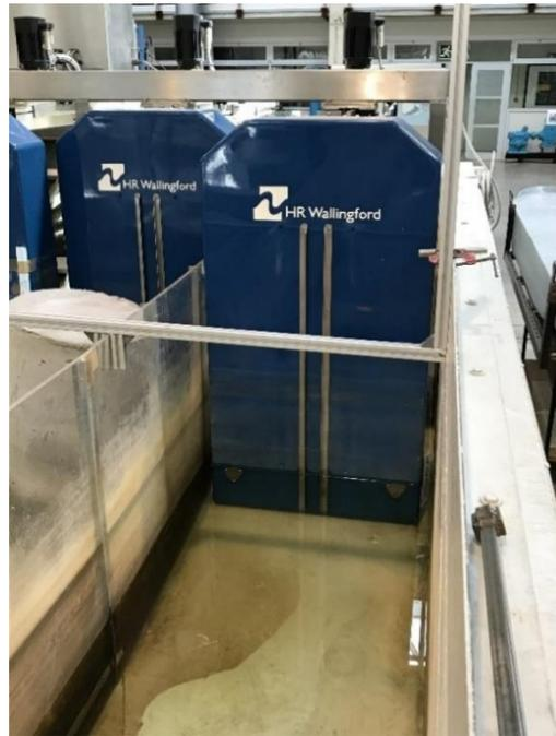
Fig. 4.5 - Pormenor das pás, e dos elementos metálicos verticais parte integrante do mecanismo ativo de absorção da reflexão.
