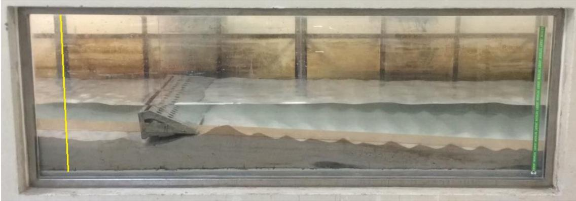
Fig. 4.54 - Estado final do perfil transversal da praia depois da ação das ondas, para o nível de BM.
