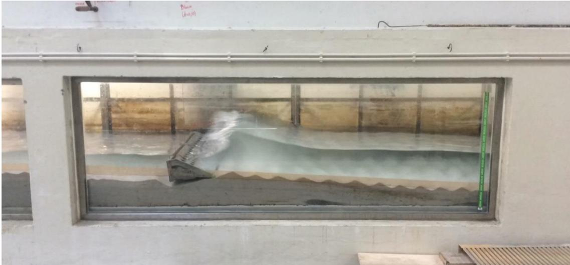
Fig. B 15 Onda antes de rebentar sobre o modelo liso do bloco para o nível de BM.
