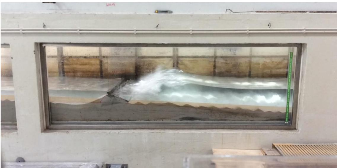
Fig. B 17 - Onda a atingir os blocos do modelo liso (configuração 0.20 +0.40 m), para o nível de BM.
