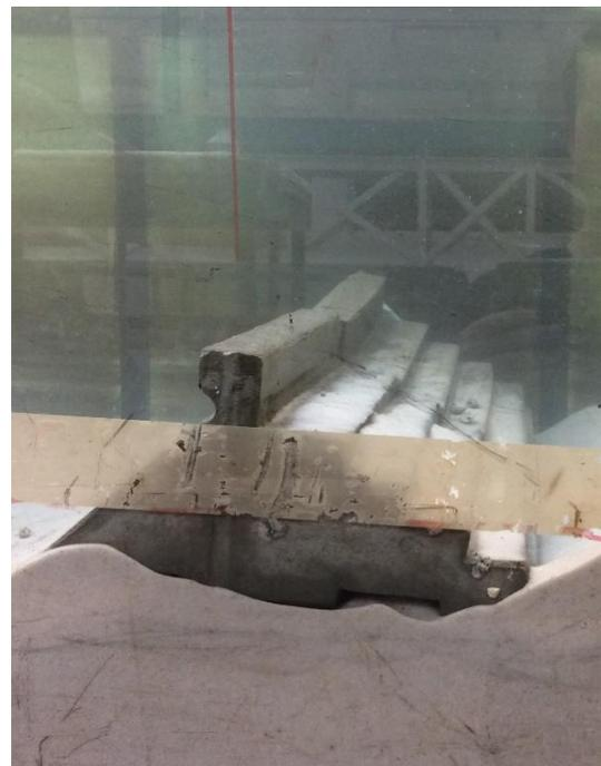
Fig. 4.52 - Bloco na posição final (o desenho a preto no vidro representa a posição inicial).
