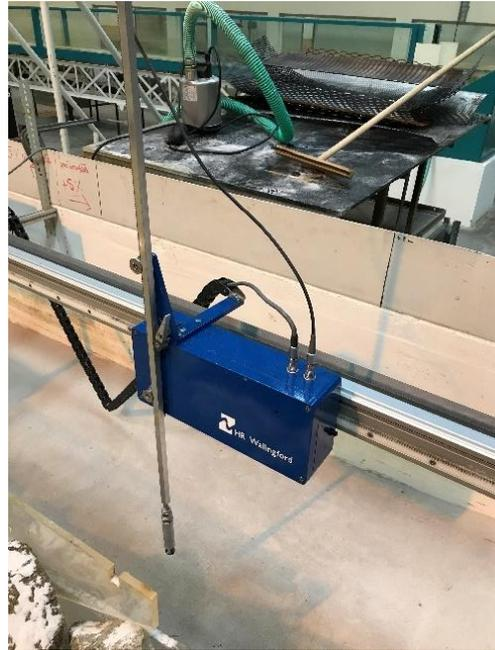
Fig. 4.9 - Elemento de suporte (azul) e haste vertical.
