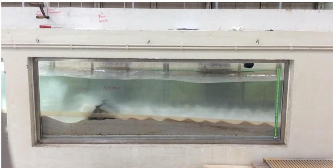
Fig. B 9 - Movimentação de sedimentos após a passagem da onda para o nível de PM.
