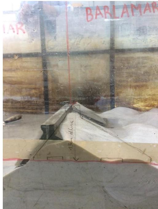
Fig. 4.42 - Bloco na posição final (o desenho a preto no vidro representa a posição inicial).
