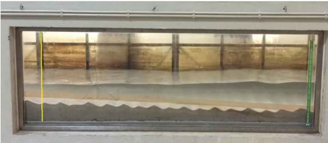
Fig. 4.30 - Estado final do perfil transversal da praia depois da ação das ondas, para o nível de BM.
