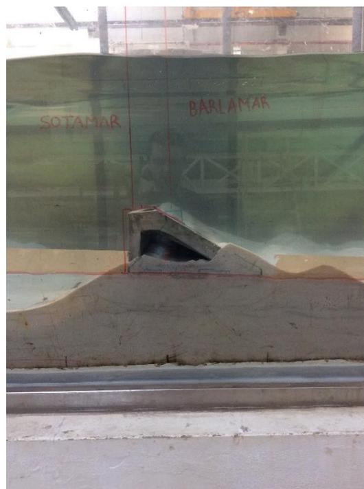
Fig. 4.62 - Bloco na posição final, (o desenho a vermelho no vidro representa a posição inicial).
