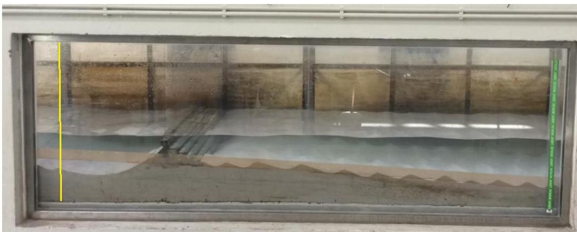
Fig. 4.44 - Estado final do perfil transversal da praia depois da ação das ondas, para o nível de BM.
