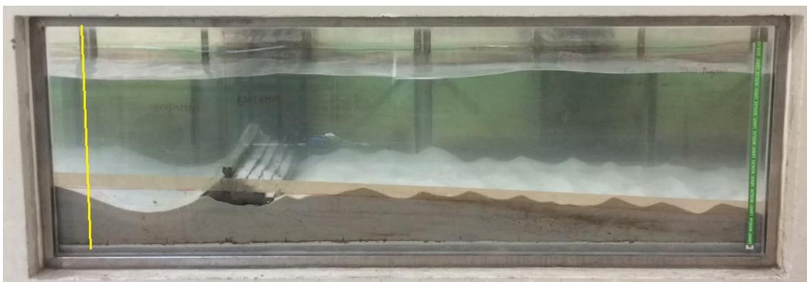
Fig. 4.49 - Estado final do perfil transversal da praia depois da ação das ondas, para o nível de PM.
