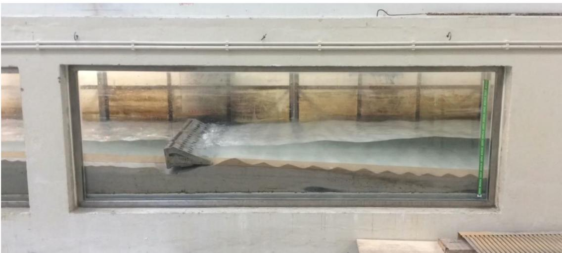
Fig. B 14 Efeito descarregador do bloco para o nível de BM.
