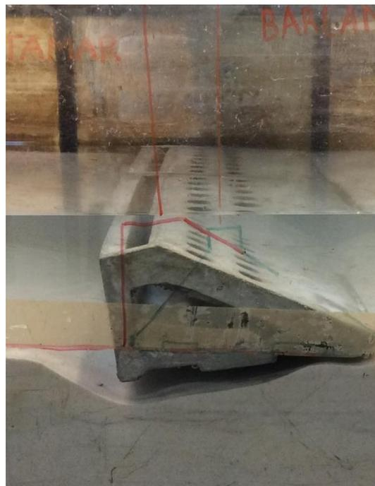
Fig. 4.57 - Bloco na posição final (o desenho a vermelho no vidro representa a posição inicial).
