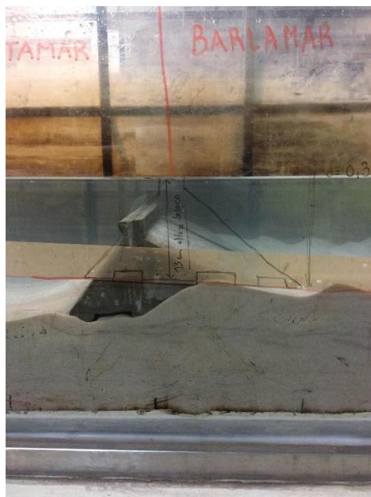
Fig. 4.36 - Bloco na posição final, o desenho a preto no vidro representa a posição inicial.
