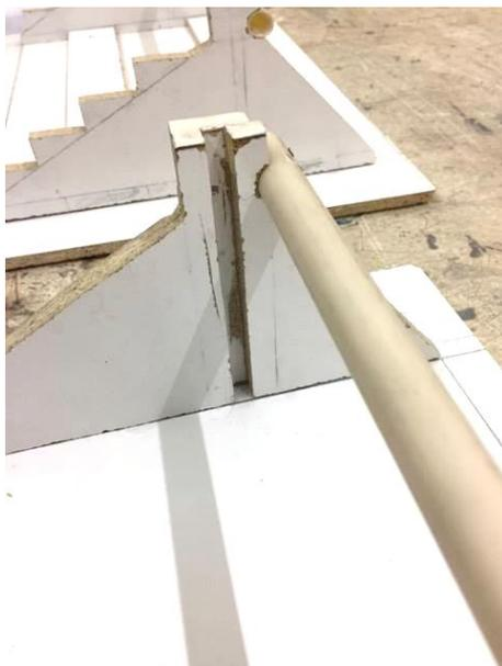
Fig. 3.5 - Pormenor da interligação entre blocos no molde de construção do modelo liso, vista de dentro.
