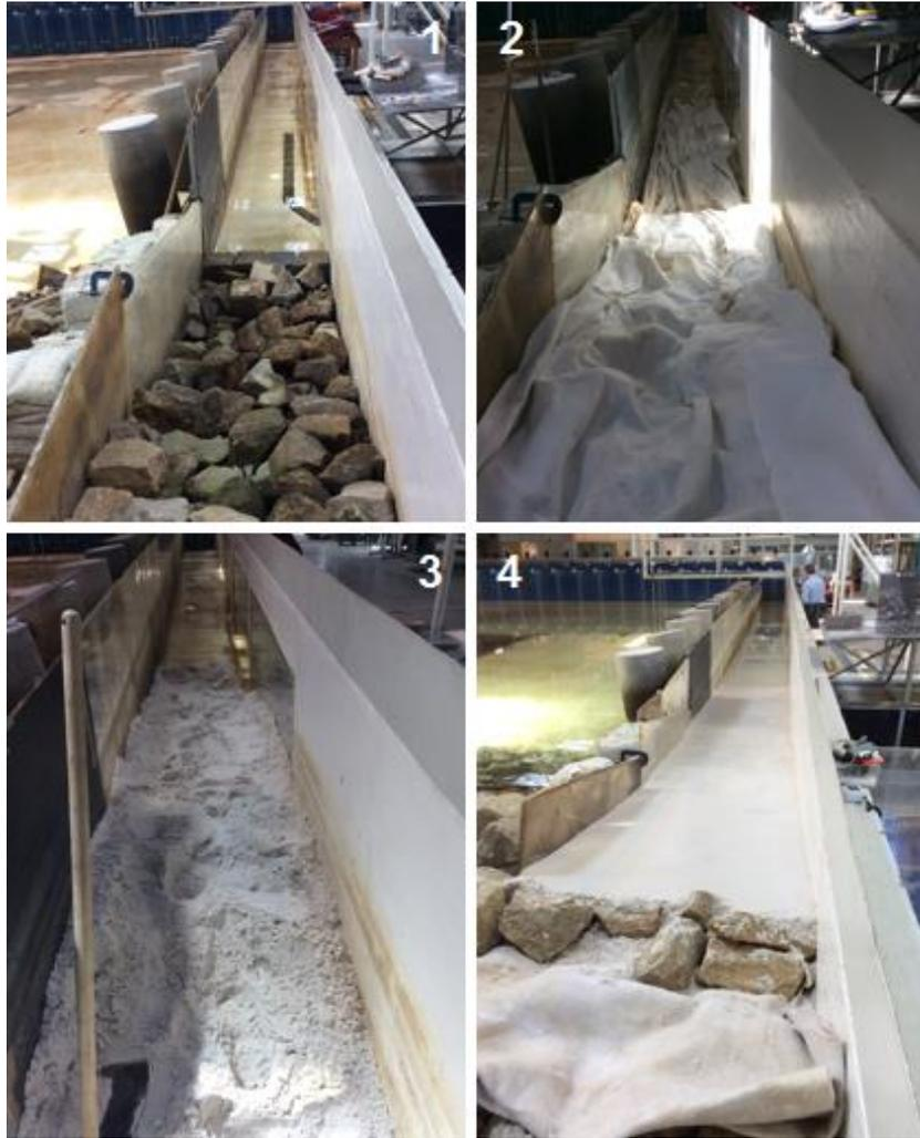
Fig. 4.10 - Sequência construtiva da praia de areia utilizada nos ensaios do *SWED-Block*.
