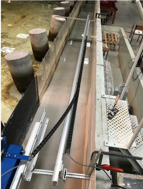
Fig. 4.8 - Carril por onde se desloca o elemento de suporte do perfilador.
