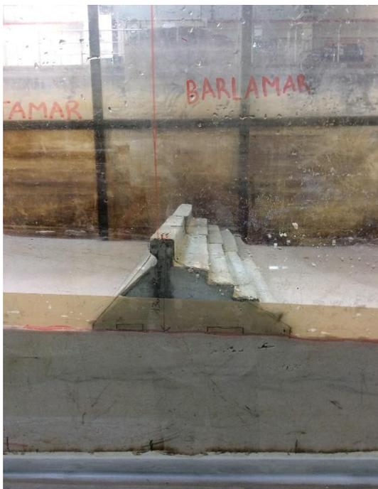
Fig. 4.51 - Bloco na posição inicial, antes de ser testado para o nível de PM.
