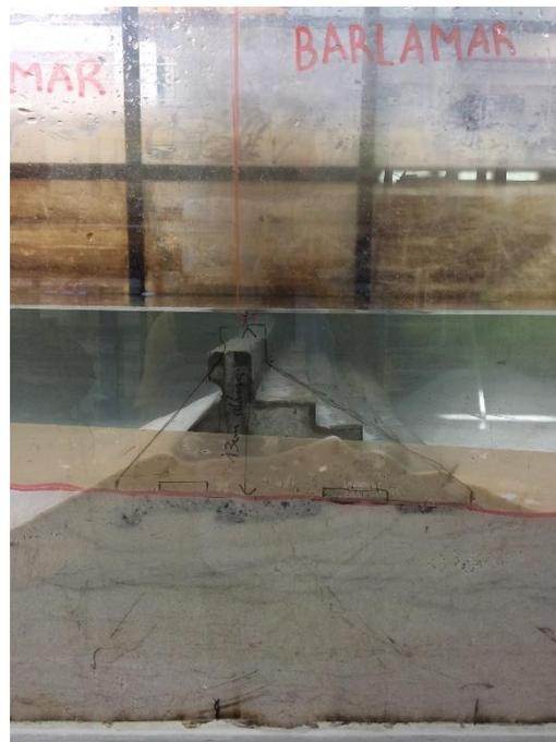
Fig. 4.47 - Bloco na posição final (o desenho a preto no vidro representa a posição inicial).
