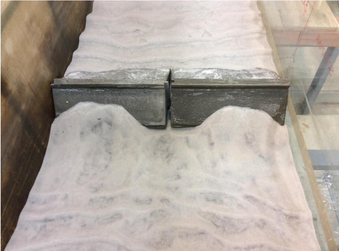
Fig. B 3 Modelo liso depois dos ensaios para o nível de BM.
