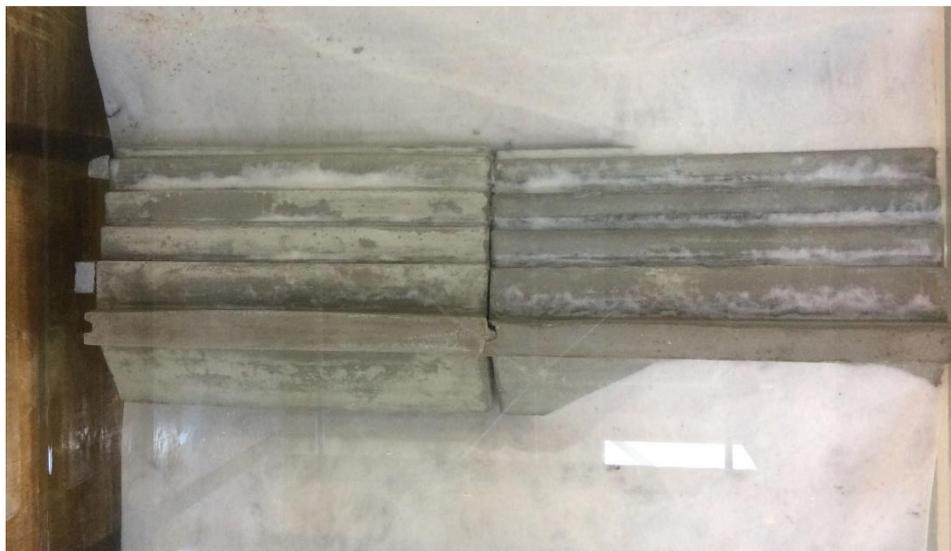
Fig. 4.48 - Posição final dos blocos do modelo rugoso, vista de cima.
