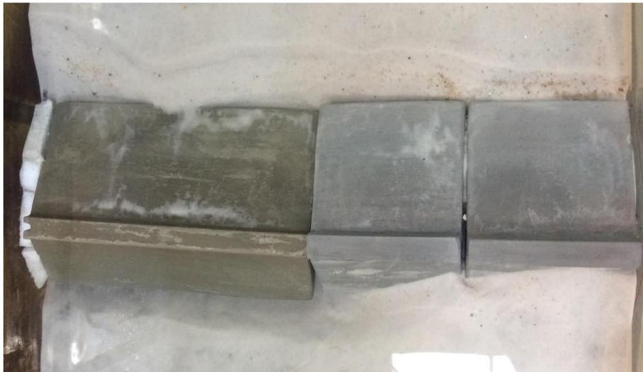
Fig. 4.68 - Posição final dos blocos do modelo liso com 0.20 m, vista de cima.
