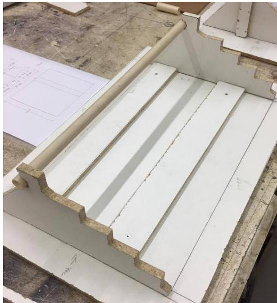
Fig. 3.7 - Molde em madeira para o modelo rugoso, onde são visíveis os elementos que conferem uma fundação irregular aos blocos.
