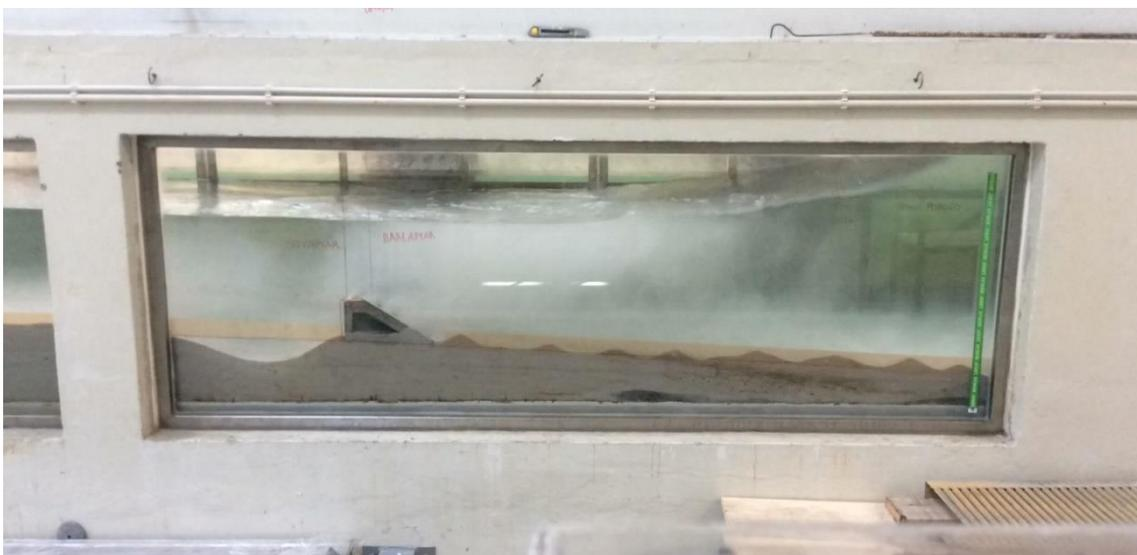
Fig. B 16 - Movimentação de sedimentos em redor do modelo poroso para o nível de BM.
