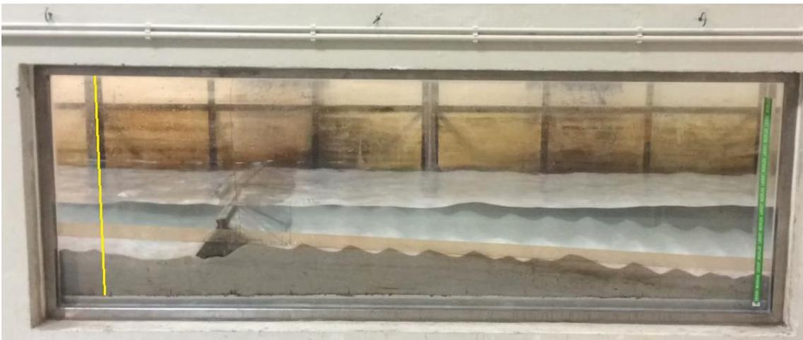
Fig. 4.34 - Estado final do perfil transversal da praia depois da ação das ondas, para o nível de BM.
