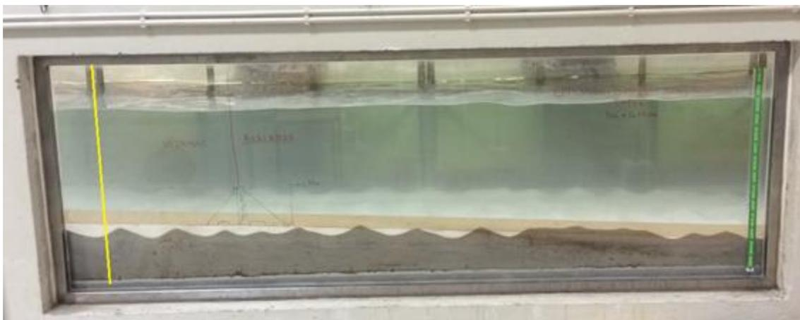
Fig. 4.32 - Estado final do perfil transversal da praia depois da ação das ondas, para o nível de PM.
