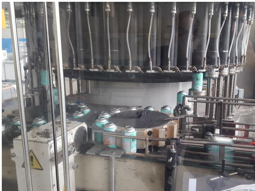
Figura 67 - Ensaio de fugas
