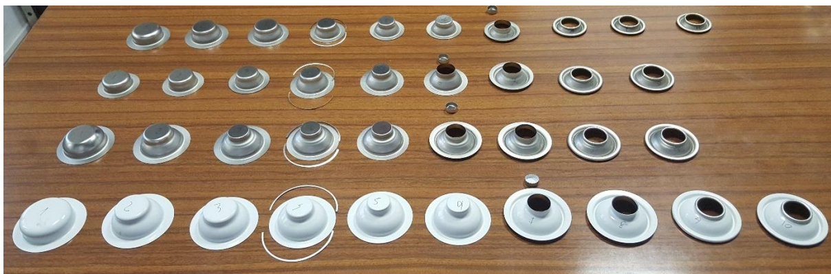
Figura 58 - Estágios de embutidura das várias cúpulas
