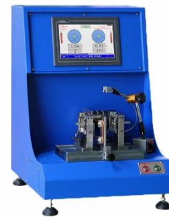
Figura 3.10: Máquina de equilibrar com apoios flexíveis (JP Balancer 2013).
