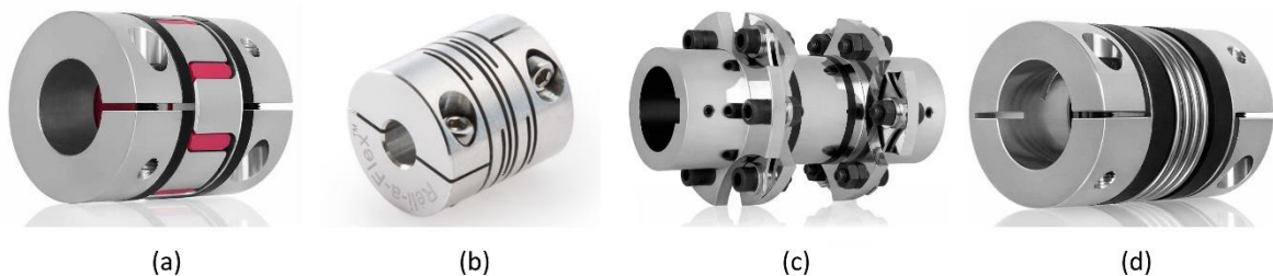
Figura 4.8: Acoplamentos permanentes flexíveis: (a) de elastômero, (b) de rasgo helicoidal, (c) de disco e (d) de fole (R+W® 2017).
