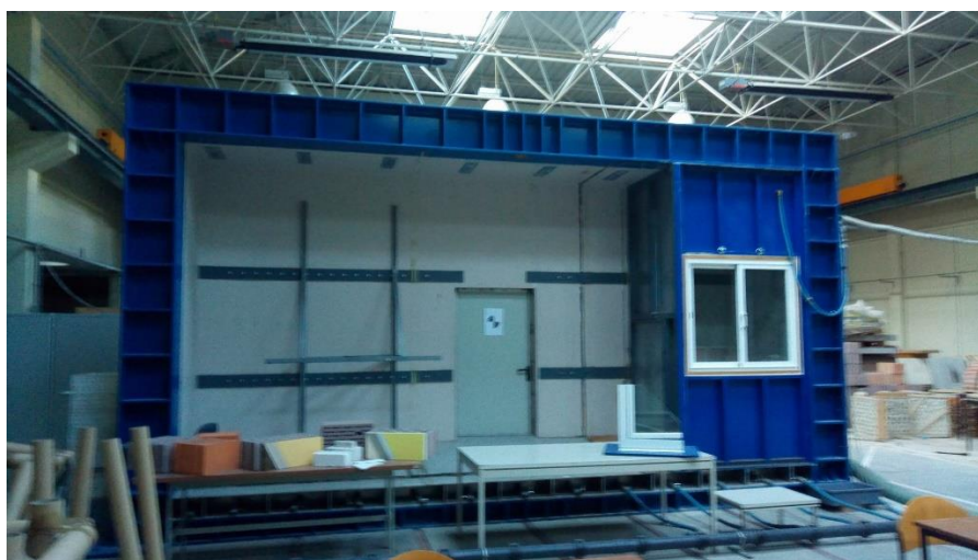
Figura 19 – Material de ensaio segundo a EN 12114
