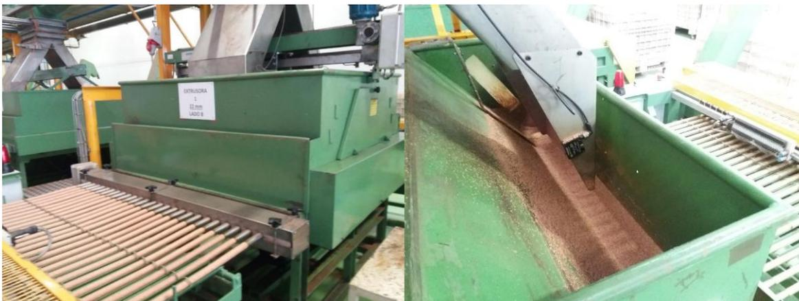
*Figura 2.1 - Extrusora utilizada na produção de rolha NT.*
