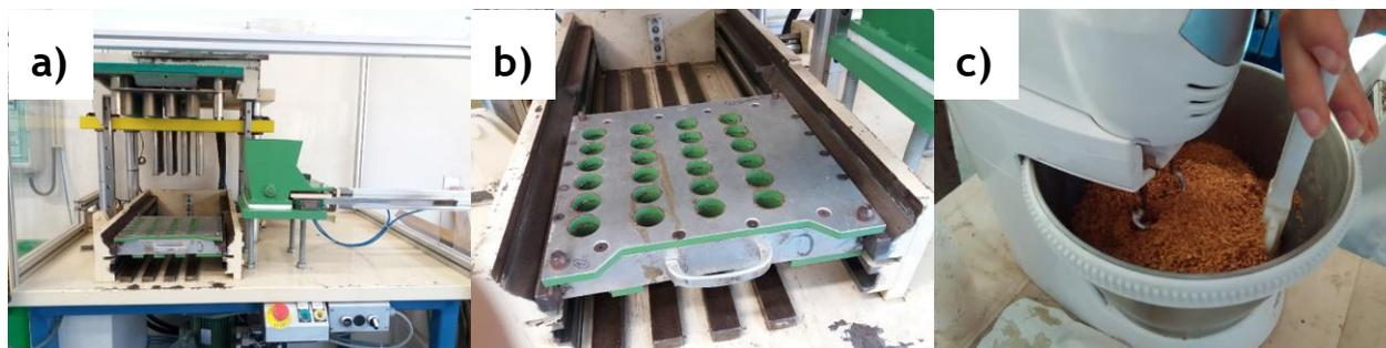
Figura 3.2 - Moldadora piloto (a), moldes utilizados (b) e misturadora (c).
