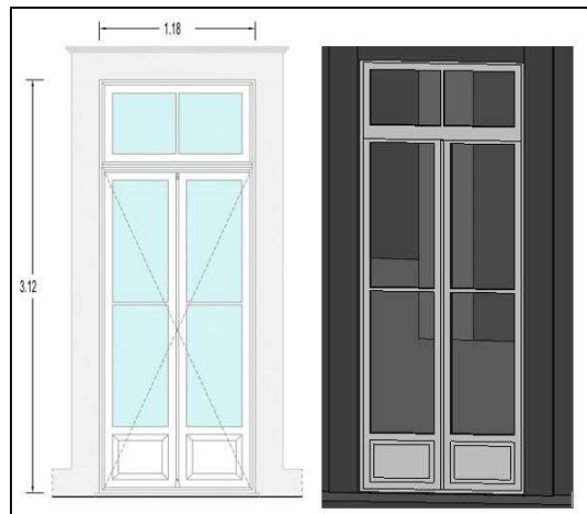
Fig.5.12 - Representação do vão “PE”, esquema em Alçado (esquerda) e vista 3D, Revit (direita)
