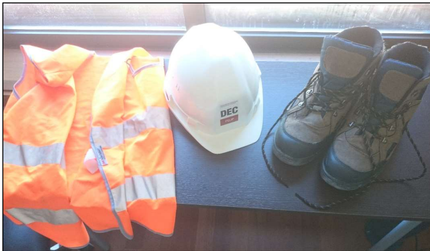
Fig.5.13 – EPI's utilizados (da esquerda para a direita): colete, capacete e botas com biqueira de aço
