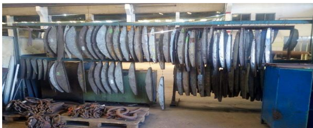
Figura 26 – Estrutura suporte aos raios utilizados como apoio à calandragem
