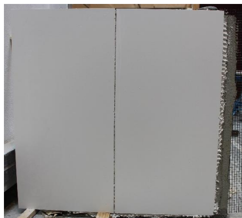
Figura 25 – Colagem com cimento-cola de presa rápida na Face A
