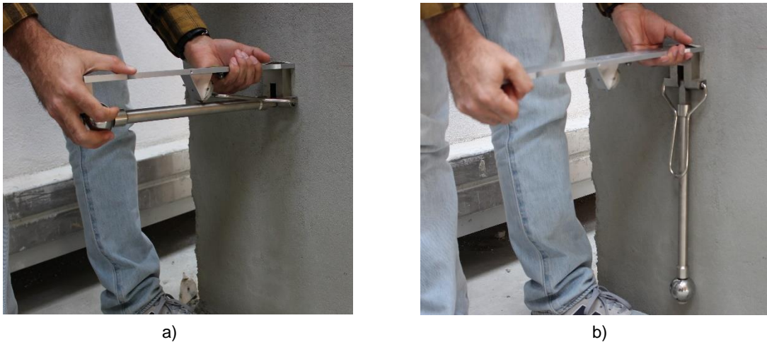
Figura 36 – a) Posicionamento do equipamento; b) Embate da esfera na parede
