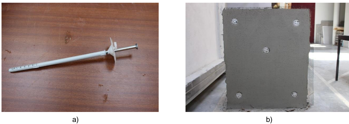
Figura 19 – a) Parafuso e bucha para fixação mecânica; b) Disposição das fixações mecânicas na Face A
