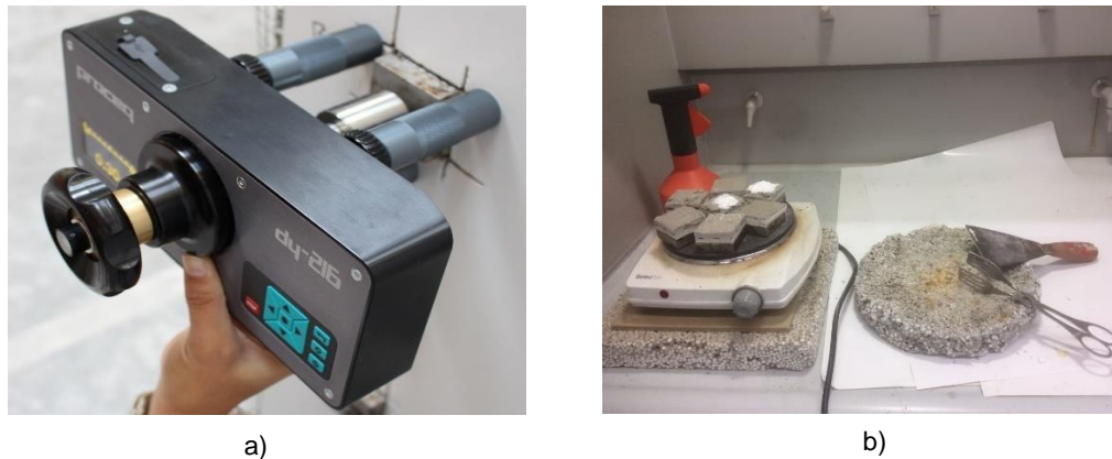
Figura 40 – a) Execução do arrancamento; b) Limpeza das pastilhas
