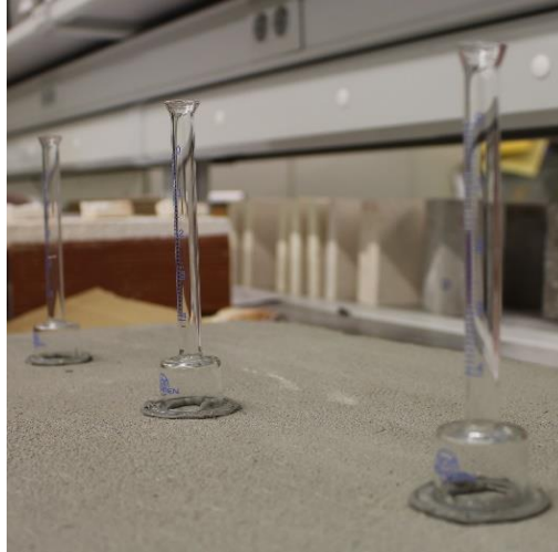
Figura 42 – Execução do ensaio de permeabilidade no Painel I (Ip 1 , Ip 2 e Ip 3 )
