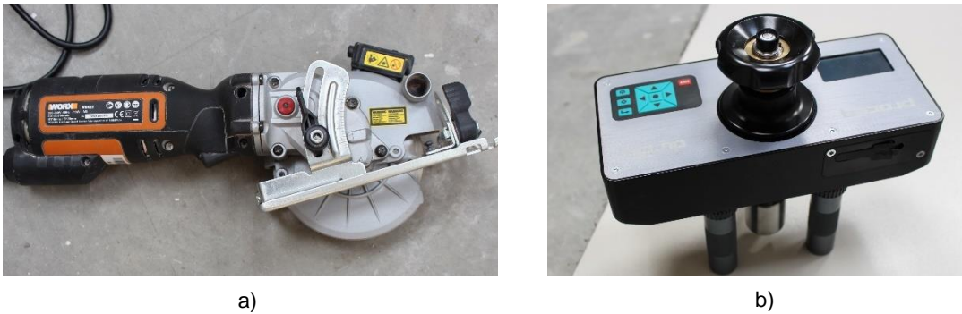
Figura 37 – a) Rebarbadora; b) Equipamento de arrancamento e medição da aderência
