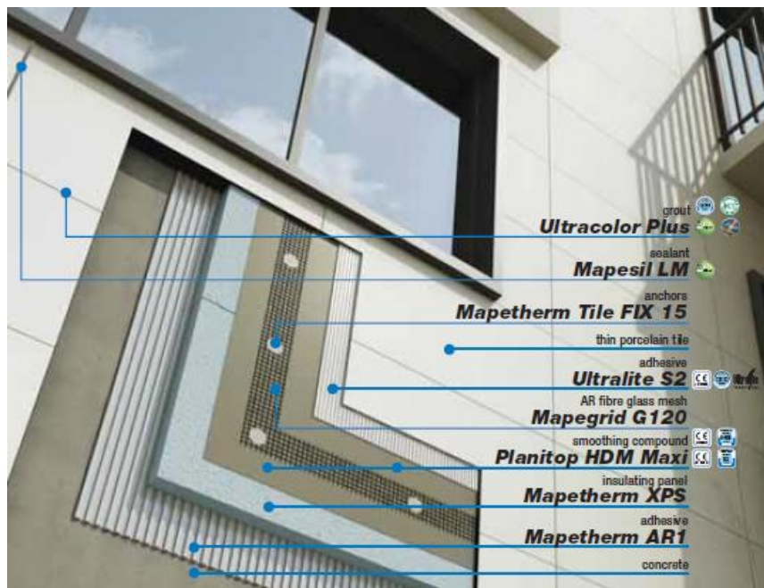
Figura 5 – Esquema geral do Mapetherm ® Tile System [39]
