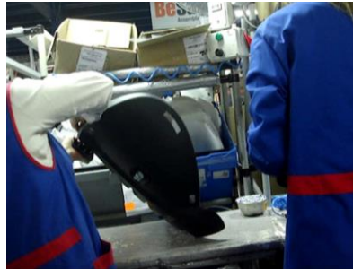
Figura 47 – Montagem da peça de fricção no encosto.
