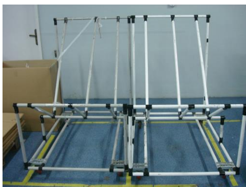
Figura 38 – Racks usados no abastecimento posterior da linha de montagem.
