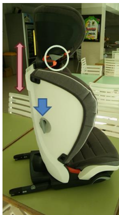
Figura 27 – Manípulo de elevação do encosto de cabeça.
