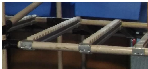
Figura 14 – Calhas de rolos dos racks do bordo de linha.
