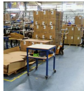
Figura 37 – Mesa de apoio ao trabalho colocada no circuito do mizusumashi .
