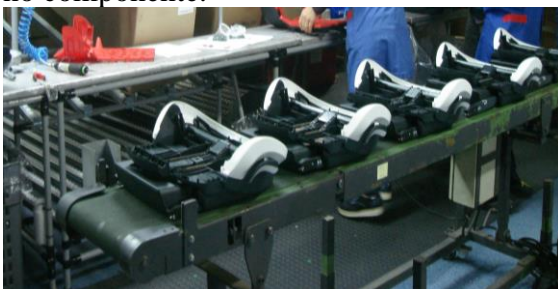
Figura 43 – Tapete rolante a movimentar cinco bases da cadeira iZi Flex .
