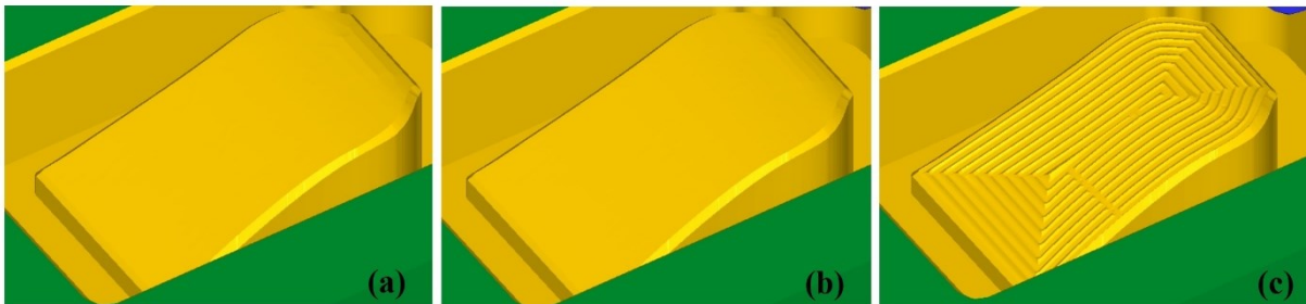
Figura 34 - Acabamento com a ferramenta 1 (a), acabamento com a ferramenta 2 (b), acabamento com a ferramenta 3 (c).
