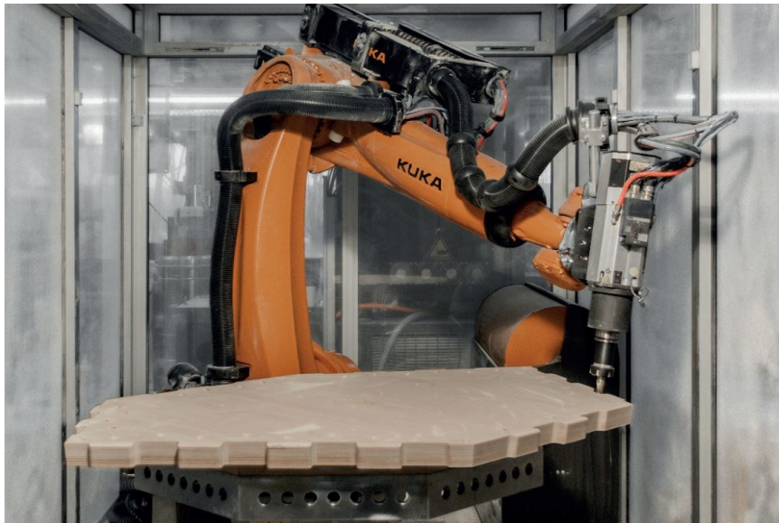
Figura 1 - Robô industrial de 6 eixos a maquinar peça em madeira [5].
