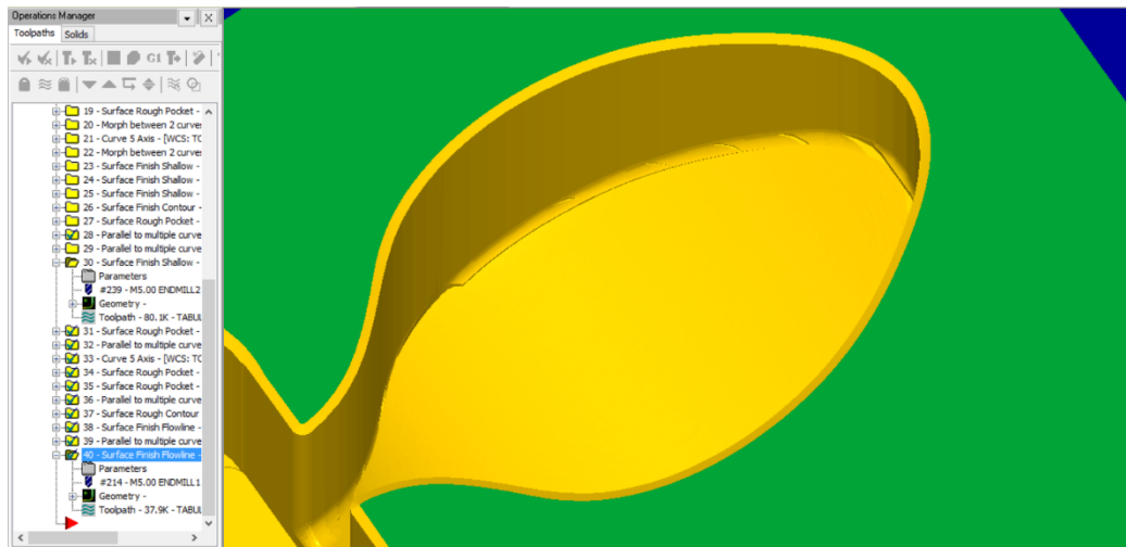
Figura 20 - Cavidade para colheres resultante do processo de acabamento (maquinação de 5 eixos).
