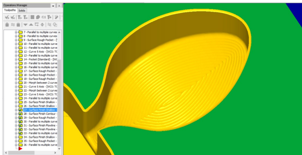
Figura 19 - Marcas superficiais resultantes do processo de acabamento (maquinagem de 3 eixos).
