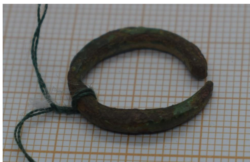
Figura 173 Pormenor da argola aberta e das pequenas manchas de corrosão ativa na parte superior.
