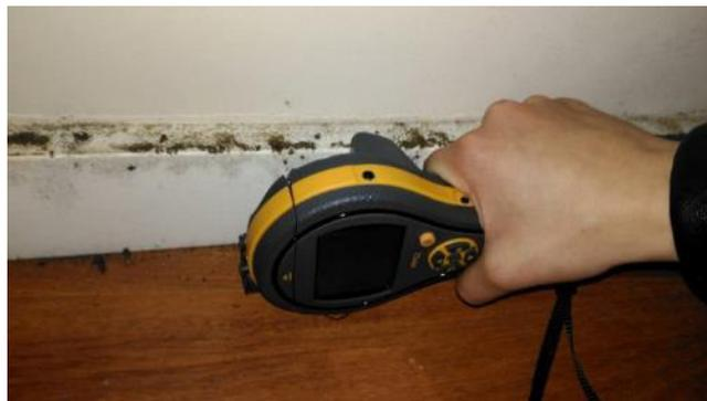
Ensaio Caso A - Protimeter MMS2
