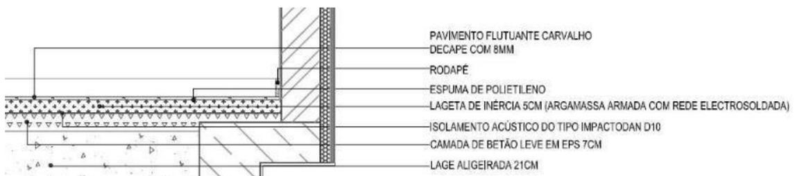
Corte construtivo de pavimento interior (Porto Vivo, SRU)
