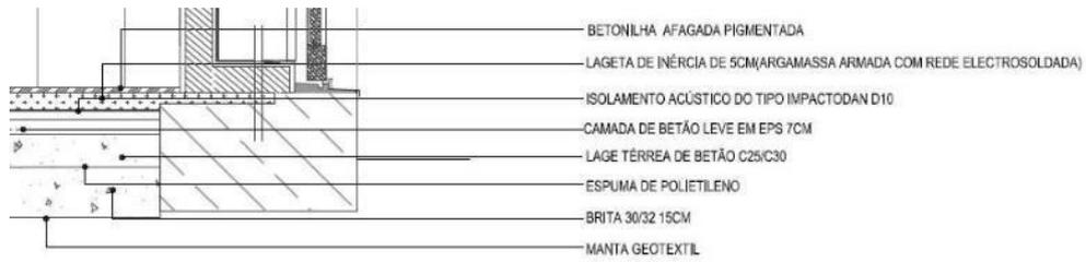
Corte construtivo de pavimento interior (Porto Vivo, SRU)
