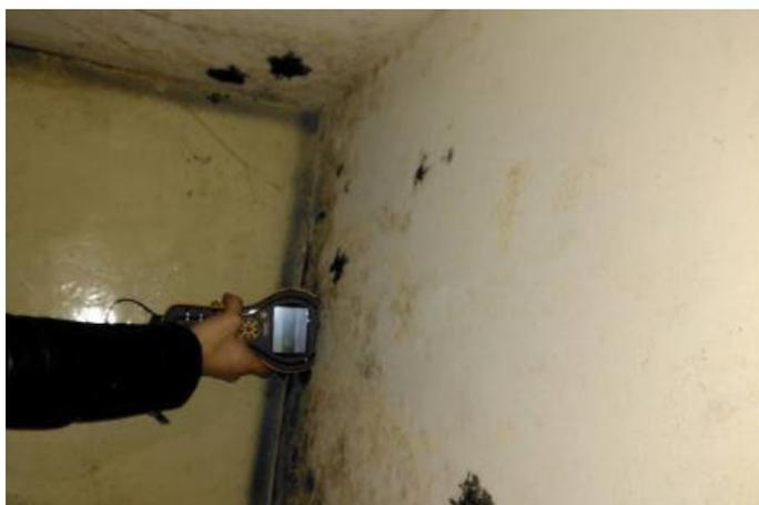
Ensaio Caso C - Protimeter MMS
