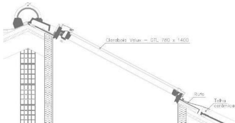
Corte construtivo de claraboia (Porto Vivo, SRU)
