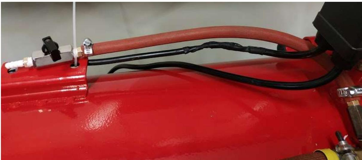
Figura 31-Válvula de alívio manual.
