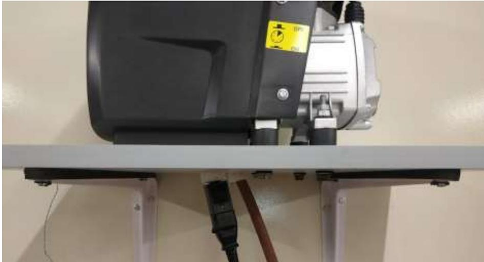
Figura 21- Isolamento colocado na prateleira e nos apoios do motor.
