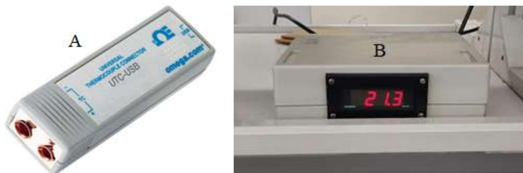
Figura 25- Leitor USB universal de termopares (A) e display para leitura de temperaturas de termopares (B).
