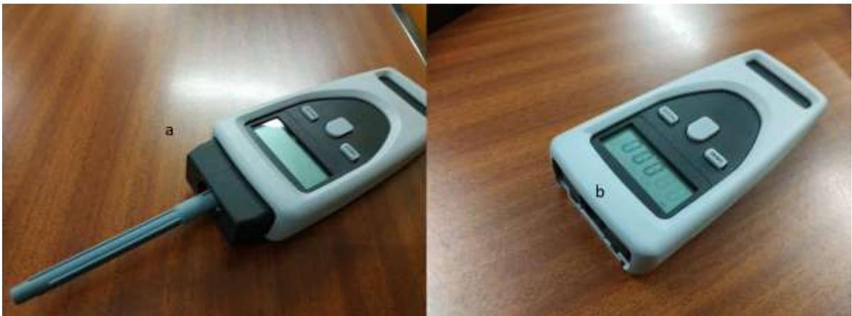
Figura 36-Leitor ótico utilizado com o acessório de medição por contacto (a) e sem este (b).
