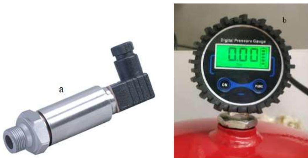
Figura 26-Transdutor de pressão (a) e manómetro (b) utilizados.
