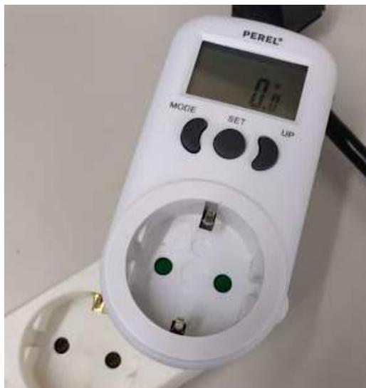
Figura 32-Medidor de potência elétrica da Perel.
