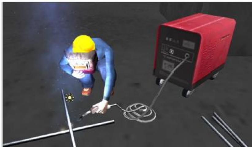
Fig. 3.11 – Execução inadequada de uma soldadura [4]
