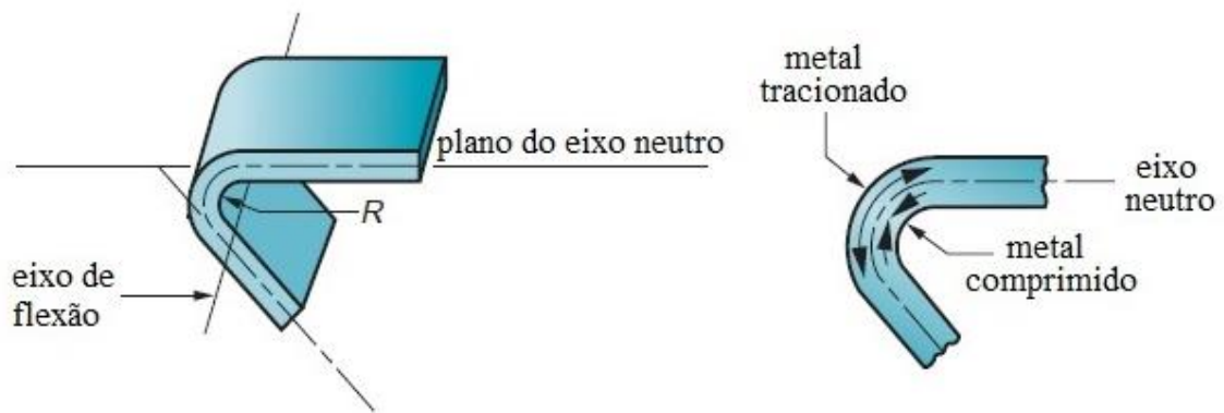
Figura 8 – Processo de conformação (adaptado de Groover, 2010)
