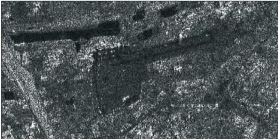
**Figura 5.** Imagem SAR do satélite ERS-2 da ESA do Aeroporto de Linate, na região Este de Milão, Itália (figura obtida de Ferretti et al., 2007). O ruído ‘sal-e-pimenta’ nas regiões circundantes do aeroporto é devido ao efeito de *speckle*.
