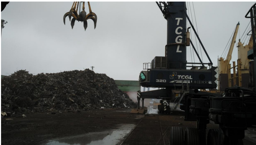
Figura 2.14 – Grua móvel a descarregar sucata do navio (lado direito da Figura), para o local de armazenamento
