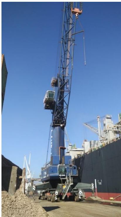
Figura 2.12 – Descarga da estilha do navio para o cais através da tremonha (Grua Móvel sobre pneumáticos, altura aproximada da cabine 23m)
