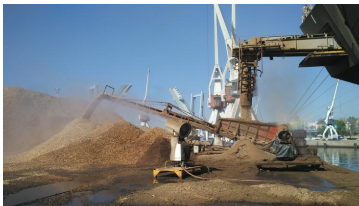
Figura 2.11 – Descarga da estilha do navio para o cais através da tremonha (detalhe dos expressores em funcionamento, bem como do apilhamento da estilha no final da cinta transportadora)
