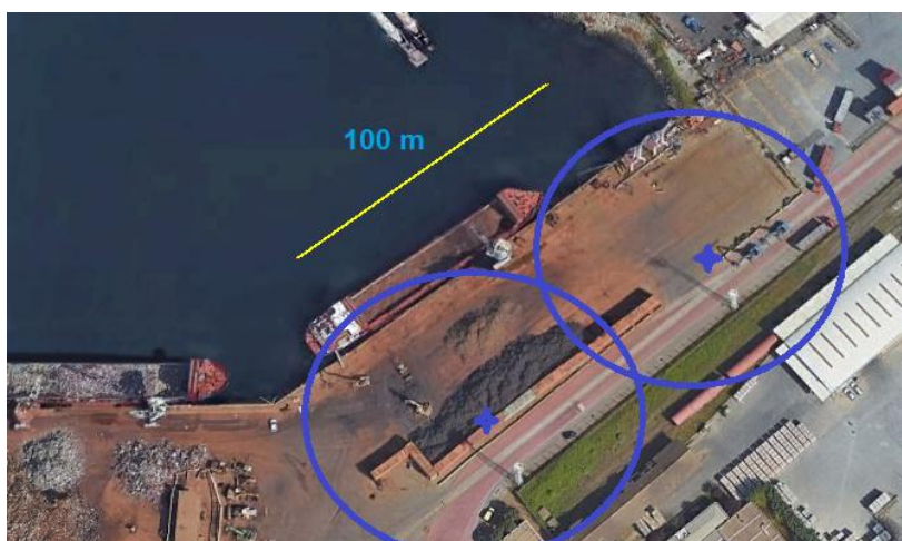
Figura 4.32 - Disposição dos monitores de água na secção 3, com a área abrangida por cada monitor de água, com alcance de 50 m
