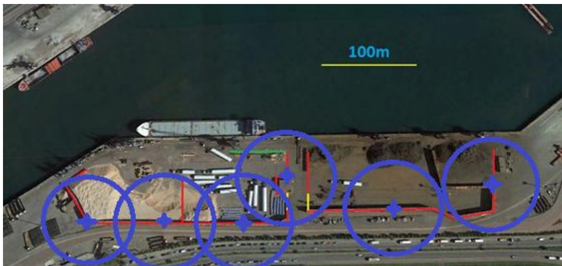
Figura 4.31 - Disposição dos monitores de água nas secções 1 e 2, com a área abrangida por cada monitor de água, com alcance de 50 m
