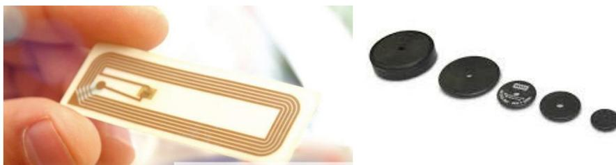
**Figura 2.3** - Exemplo de etiqueta passiva (esquerda) (OECD, 2008) e diferentes formas de etiquetas RFID (direita) (HID, 2017)
