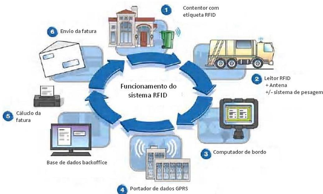
Figura 2.4 - Funcionamento do sistema RFID (adaptado de Abdoli, 2009)
