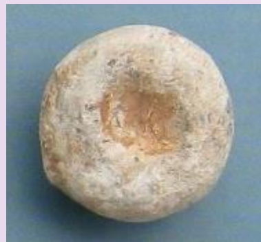
Figuur 21: Kogels met een deuk als gevolg van accidenteel dubbel laden. De schutter was er zich tijdens het strijdgewoel soms niet van bewust dat zijn schot niet was afgegaan. Hij laadde dan een tweede keer. De eerste kogel raakte de volgende, die daardoor een karakteristieke, cirkelvormige deuk vertoont (© privécollectie Erik Wauters).
