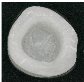
Abbildung 36 große Wandstärke bei S29
