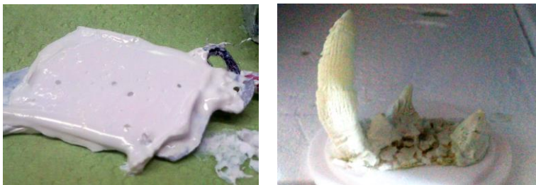
Abbildung 26 a) Abscheidung auf Zinkelektrode b) Sinterprodukt von a
