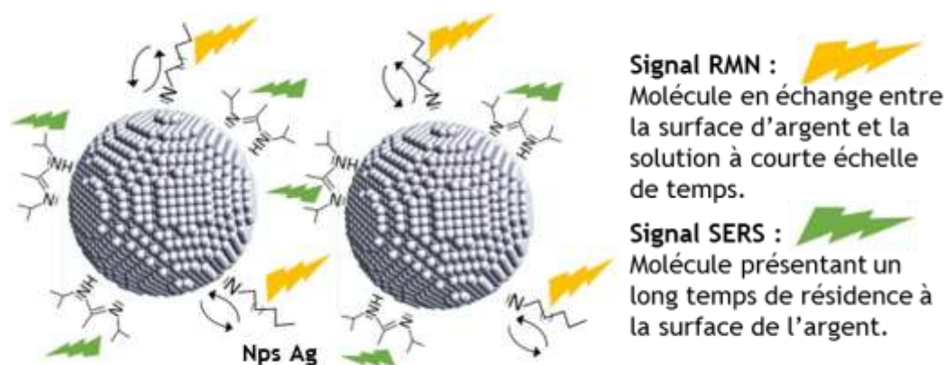
Schéma VI-3 : Représentations de deux nanoparticules d'argent stabilisées d'une part par l'amidine scotchée sur la surface et d'autre part, par la HDA en échange rapide entre la surface et le milieu environnant.
