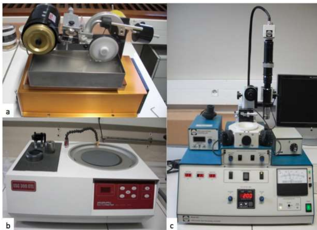
Figure VII-2 : Appareils utilisés pour la préparation des échantillons de coupe transversale avec (a) une scie à fil diamanté, (b) un polisseur mécanique et (c) Polisseur Ionique à Précision (PIPS) commercialisé par GATAN.
