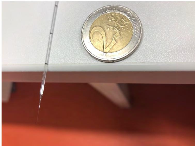
**Abb. 3.1** Injektionskanüle aus Glas für Virussuspension
