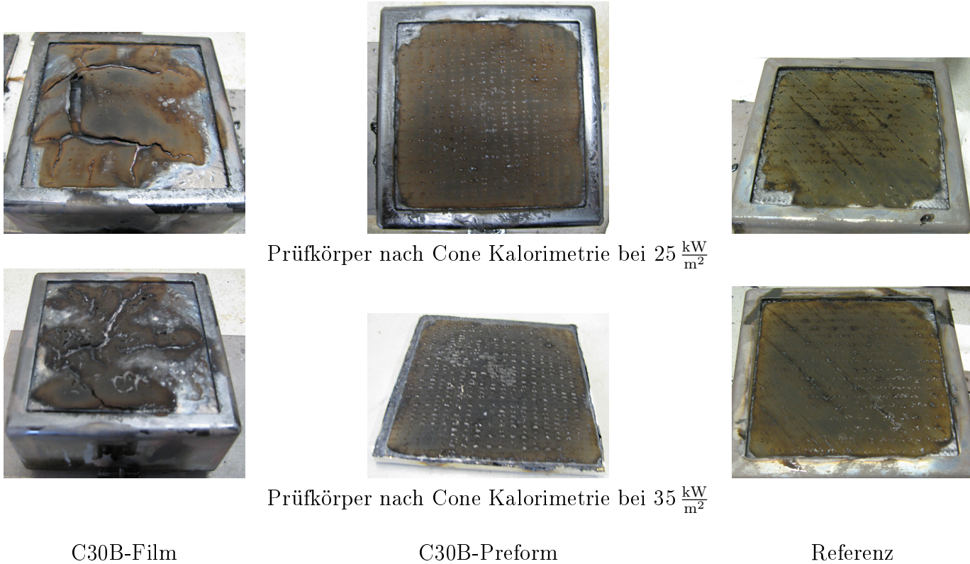
Abbildung 76: Prüfkörper nach Cone Kalorimetrie bei 25 \frac{\text{kW}}{\text{m}^2} bzw. 35 \frac{\text{kW}}{\text{m}^2}
