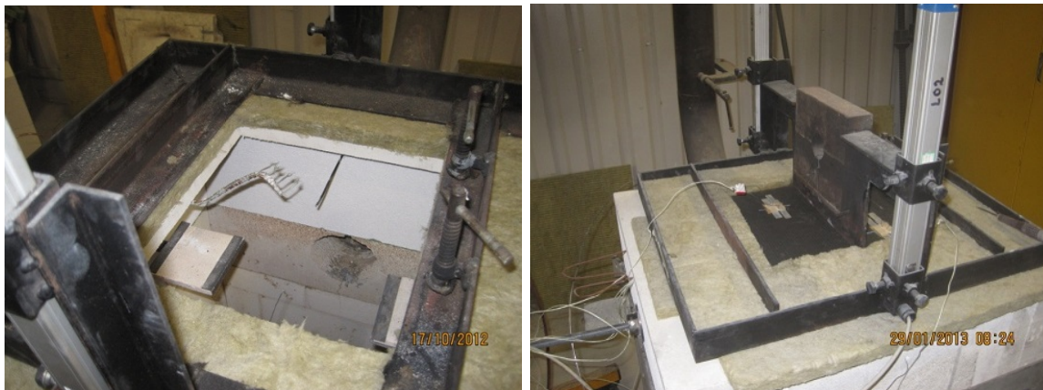
Abbildung 11: Aufbau eines Small-Scale-Furnace-Tests
