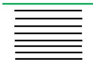
Abbildung 64: Aufbau der Proben mit einer Cetex-Lage an der Oberfläche; schwarz: Carbonfaserlage, grün: Cetex-Lage
