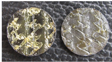
Abbildung 59: Bruchfläche nach Öffnen des delaminierten Bereichs der Multilagelaminat-Probe nach 1 min Bestrahlung
