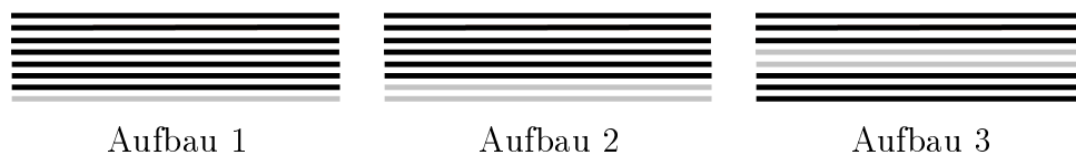
Abbildung 60: Lagenaufbau der Probekörper mit faserverstärkter Polyamidimid-Schicht (grau)
