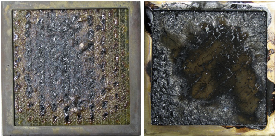
Abbildung 54: Proben nach Cone Kalorimetrie bei 25 \frac{\text{kW}}{\text{m}^2} ; links: kurz nach Entzündung, rechts: nach abgeschlossener Messung
