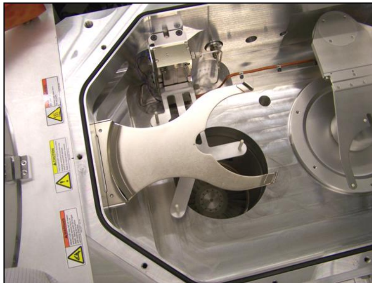
Abbildung 3.6. Endeffektor aus der Endura2 von Applied Materials, Inc., der oberhalb vom Waferlift der Theta 300i von Thermo Fisher Scientific positioniert ist.
