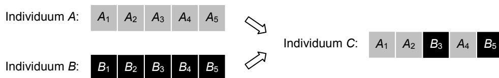
Abbildung 1-2: Beispiel einer möglichen Kombination von zwei Individuen A und B mit jeweils 5 Merkmalen zu einem neuen Individuum C
