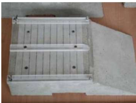
Abbildung 4: Vorrichtung zur Platzierung von Polykarbonatprobenträgern
