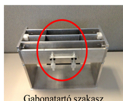
Az USA-ban 2011-ben bevezetett nedvességmérő technológia mestercellája = UGMA tesztcella
