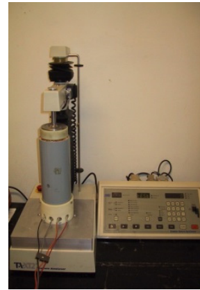
2. ábra SMS TA-XT2 precíziós penetrométer a hengerkondenzátor tesztcellával
