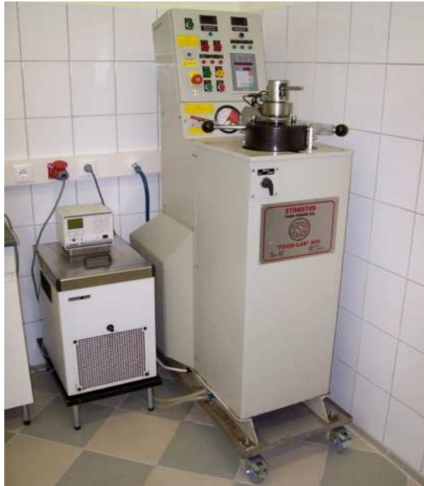
5. ábra: „FoodLab 900” nagynyomásos berendezés
