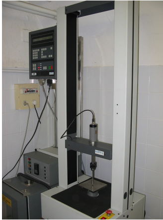
9. ábra: Lloyd 1000R típusú állománymérő készülék
