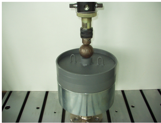
21. ábra: Ödométeres mérési összeállítás
