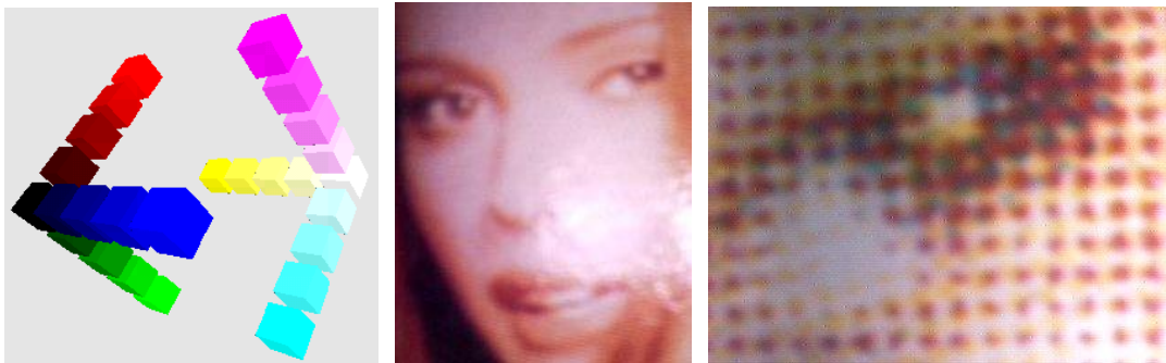
1. ábra: RGB- és CMY színtér (a). Nyomdatechnikával előállított képen (b) a szem közelről (c)
