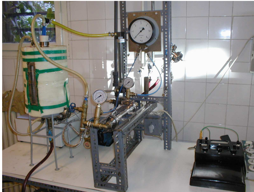
15. ábra: Az olaj-víz emulzió tisztítására használt membránszűrő berendezés.
