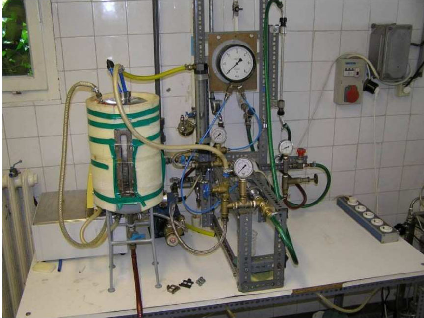
20. ábra: Fénykép a gázbefűvétással és statikus keverővel kombinált membránszűrőről.
