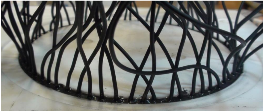
Şekil 14. Arka Yansıma Sönümlenme Polimerinin İkinci Dolgu Aşaması
