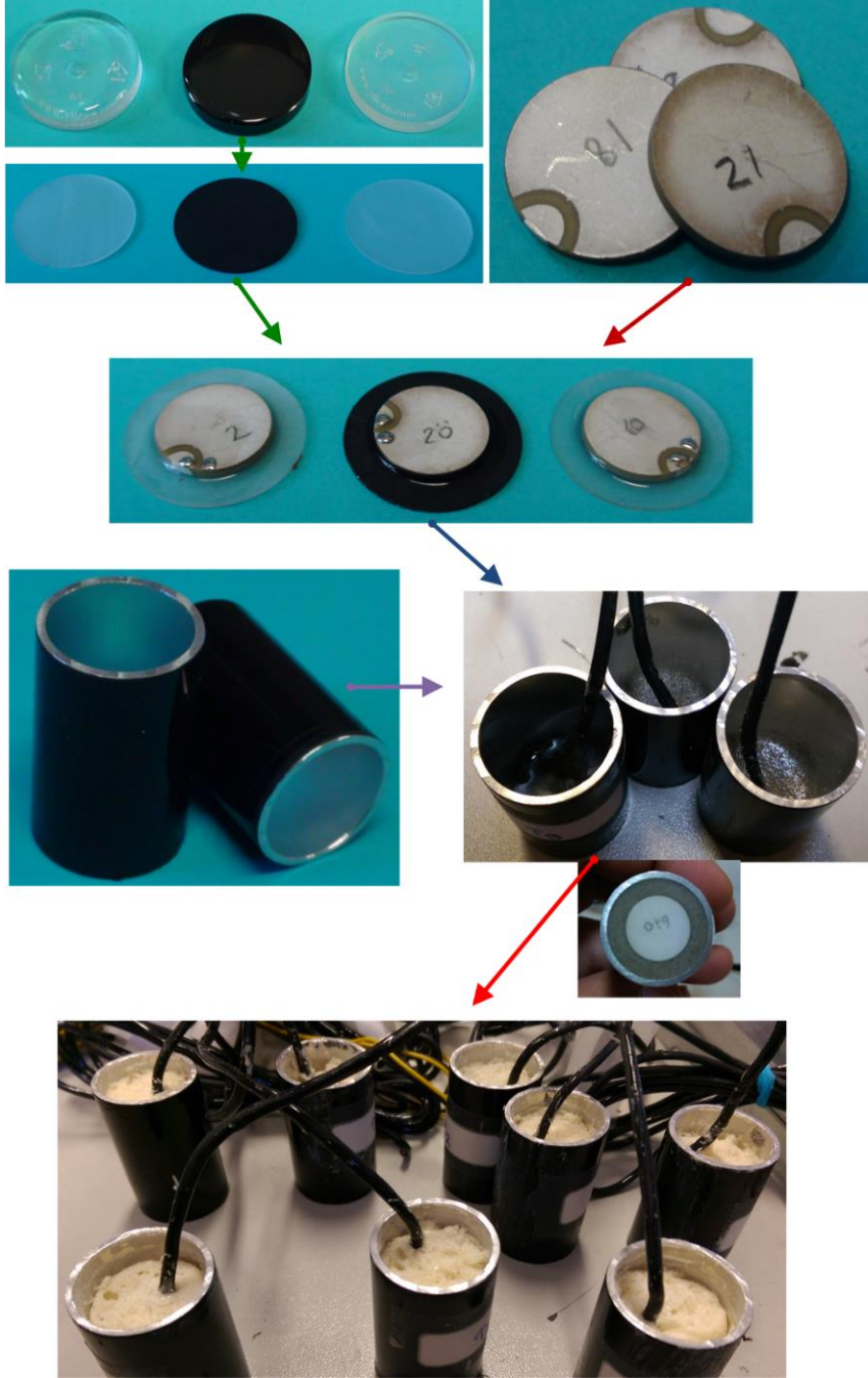
Şekil 10. Transdüser Üretim Akım Şeması
