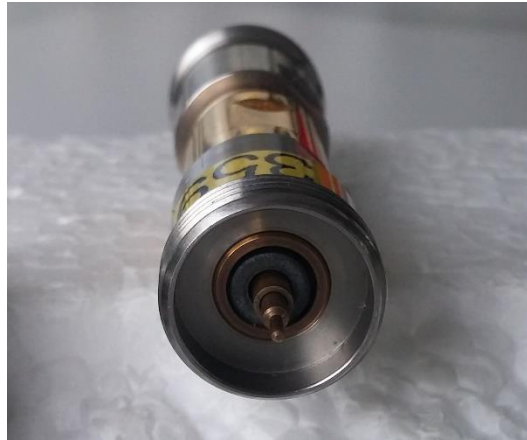
Abb. 1: Koaxiale 50 \Omega -Luftleitung mit eingefügter Ringkernprobe
