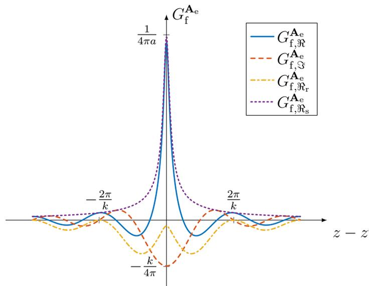
Abbildung 1: Verschiedene Anteile der Greenschen Funktion für das Vektorpotential eines langen, dünnen Drahtes und die Approximation durch deren 1. Taylor-Glied  $\mathfrak{R}_s$ , sowie der regularisierte Anteil  $\mathfrak{R}_r$ .
