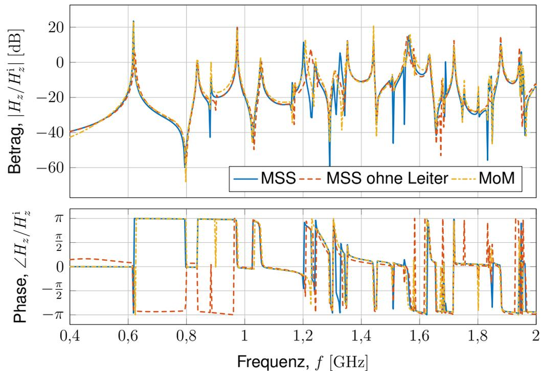
(b) Normalisiertes magnetisches Feld bei  $P_{i,2}$
