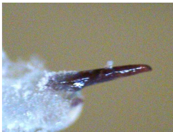
Abbildung 81 Spitze eines Kristalls auf der Glaskapillare eines Goniometerkopfes. Aufnahme durch die Mikroskopkamera des Einkristallgoniometers.
