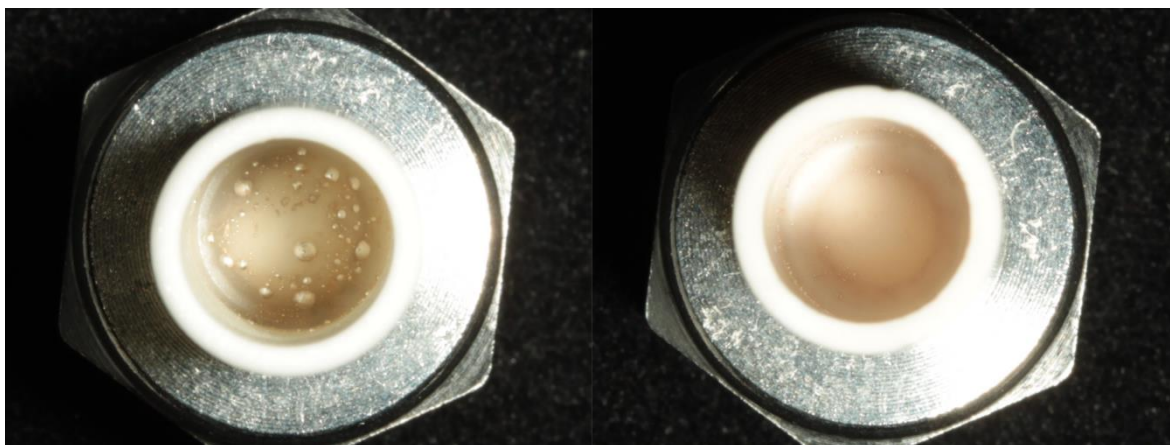
Abbildung 29 Fotografien zweier Tiegel nach einer thermogravimetrischen Messung (in einer metallischen Verschraubung als Halterung). Links: Nach der Messung einer Probe auf Basis von AgBF 4 als Silberquelle zeigt eindeutig elementares Silber. Rechts: Das Resultat desselben Messprotokolls für eine auf AgClO 4 basierende Probe zeigt keinen Rückstand.
