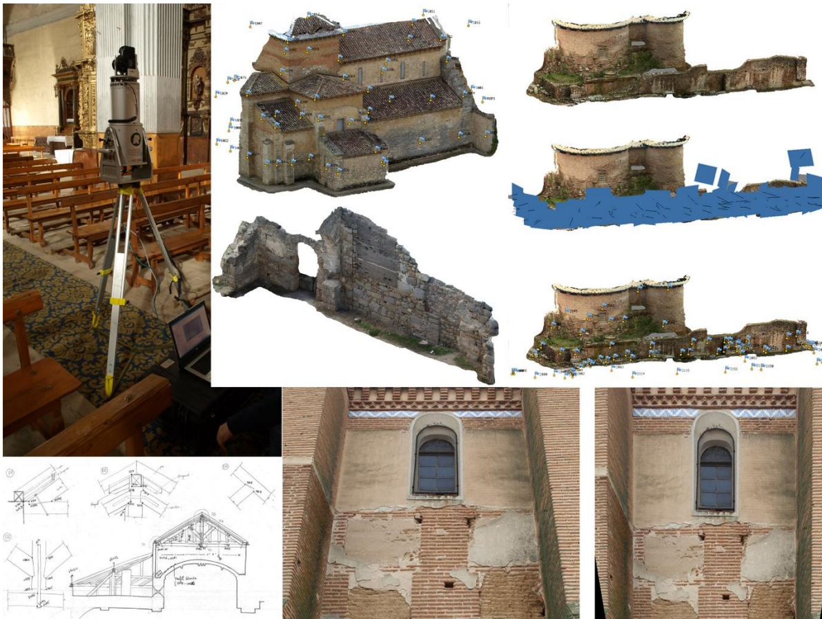
Fig. 2.2. Técnicas de levantamiento y modelado tridimensional de los bienes culturales: mediciones manuales, topografía, fotogrametría y escáner laser
