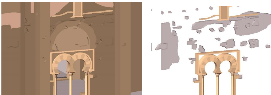
Fig. 4.5. Modelado de elementos geométricos constructivos y estratigráficos: agujeros históricos en la portada meridional de la iglesia y el relleno de los huecos.
