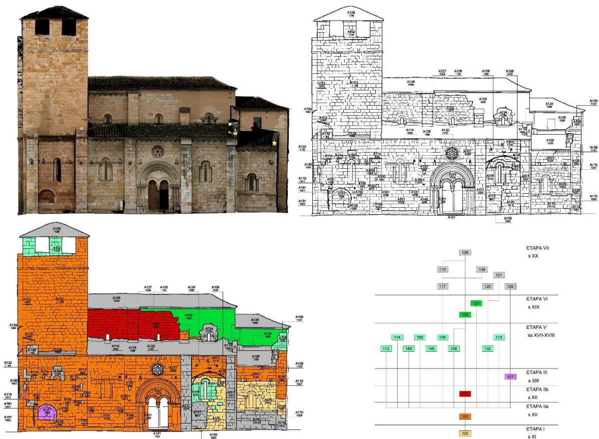
Fig. 1.2. Representación del análisis efectuado en el marco de la Arqueología de la Arquitectura de la iglesia de Santiago del Burgo, Zamora.
