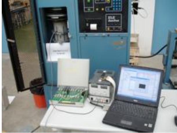
Figura 4. Ensayo de compresión simple en una probeta cilíndrica de hormigón con medida del módulo de deformación elástico
