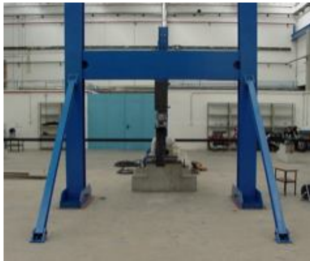
Figura 2. Pórtico de carga de 300 kN de capacidad
