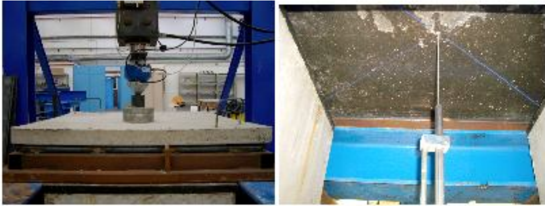
Figura 6. Ensayo de una placa de hormigón armado a punzonamiento (izq.) e instrumentación para la medida del desplazamiento vertical del punto central (dcha.)
