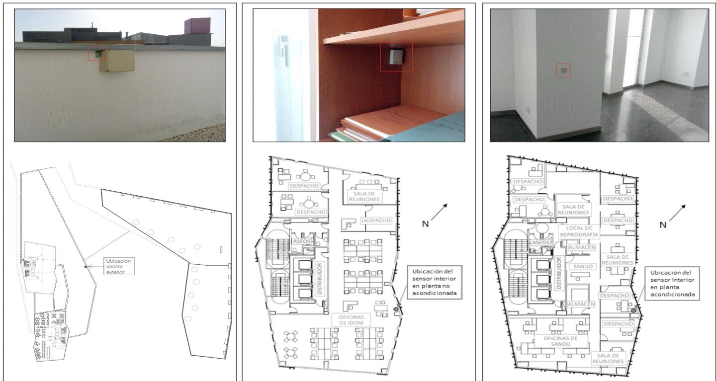
Figura 3. Sensor exterior (izquierda), interior en planta acondicionada (centro) y no acondicionada (derecha). Fuente: Elaboración los autores.
